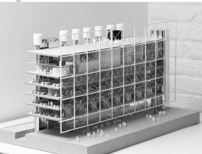
Abb.88: Südfassade - Stahlrahmenkonstruktion auf Betonstützen im Erdgeschoss, 7,5 x 7,5 m Raster mit Aussteifungselementen
