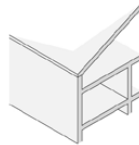
Geneigtes Dach mit Kniestock Belastbarkeit Kniestock zu überprüfen evtl. Auswirkung auf Traufkante > Abstandsflächen beachten.
