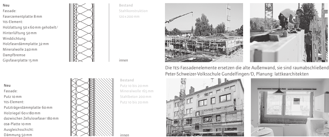
Die TES-Fassadenelemente werden vor die bestehende Fassade gehängt: Wohnhaus in der Schlägerstraße in Hannover/D, Planung: lattkearchitekten
