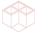
Massivbauweisen Prinzip der Kammerung, geeignet bei kongruenter oder verteiler Lastabtragung in den Bestand.
