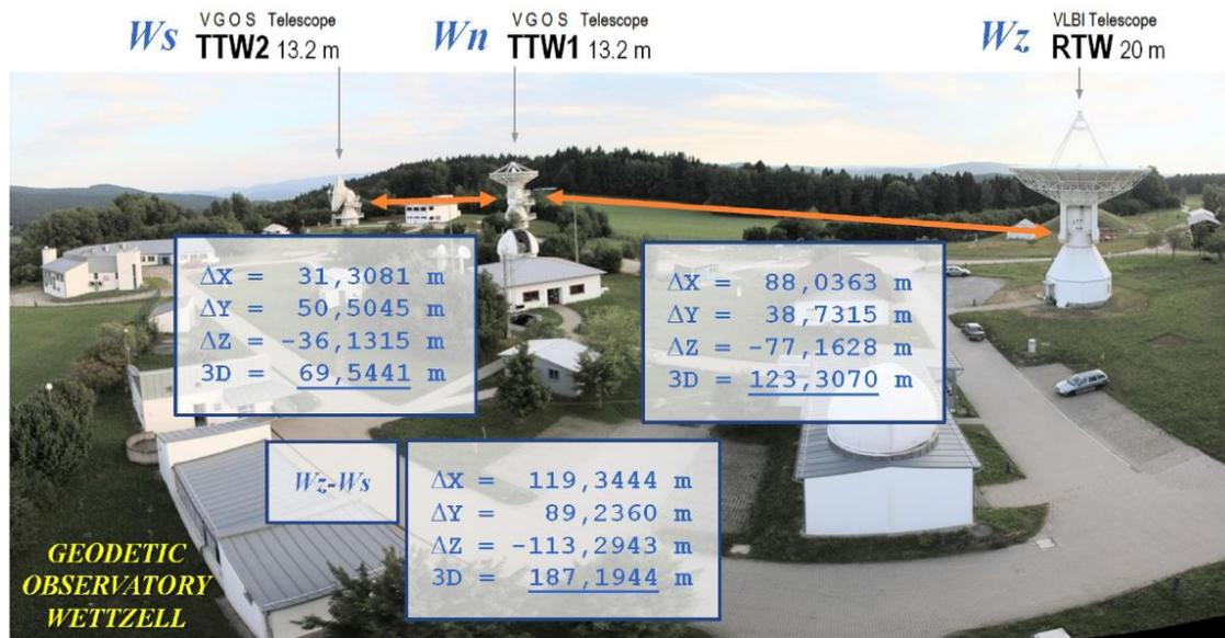
Abbildung 3.1: Panoramabild des Geodätischen Observatoriums Wettzell. In der Abbildung sind die drei VLBI Antennen (TTW1, TTW2 und RTW) zu sehen, ebenso wie deren Durchmesser und die Länge der 3D Basislinie zwischen diesen. (Schüler et al., 2018)
