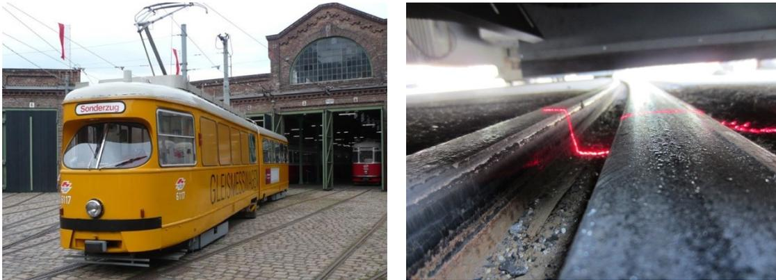
Abbildung 10: Gleismesswagen der Wiener Linien (links) mit Laser-Lichtschnitt Messvorrichtung (rechts). Fotos: Arthur Schönwälder bzw. *Plasmo*
