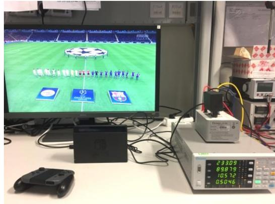
Abbildung 4.9: Nintendo SWITCH am Labor-Messplatz, eigenes Foto
