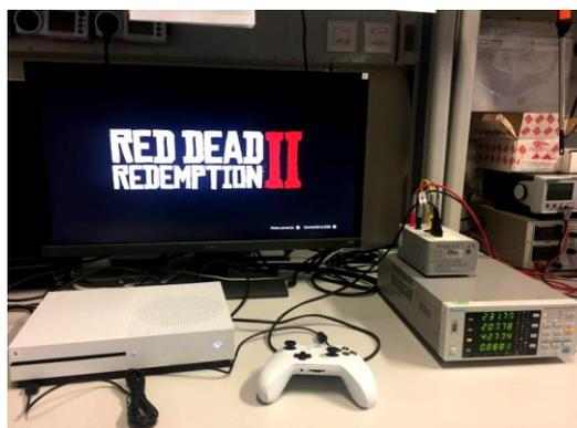
Abbildung 4.8: Xbox One S am Labor-Messplatz, eigenes Foto
