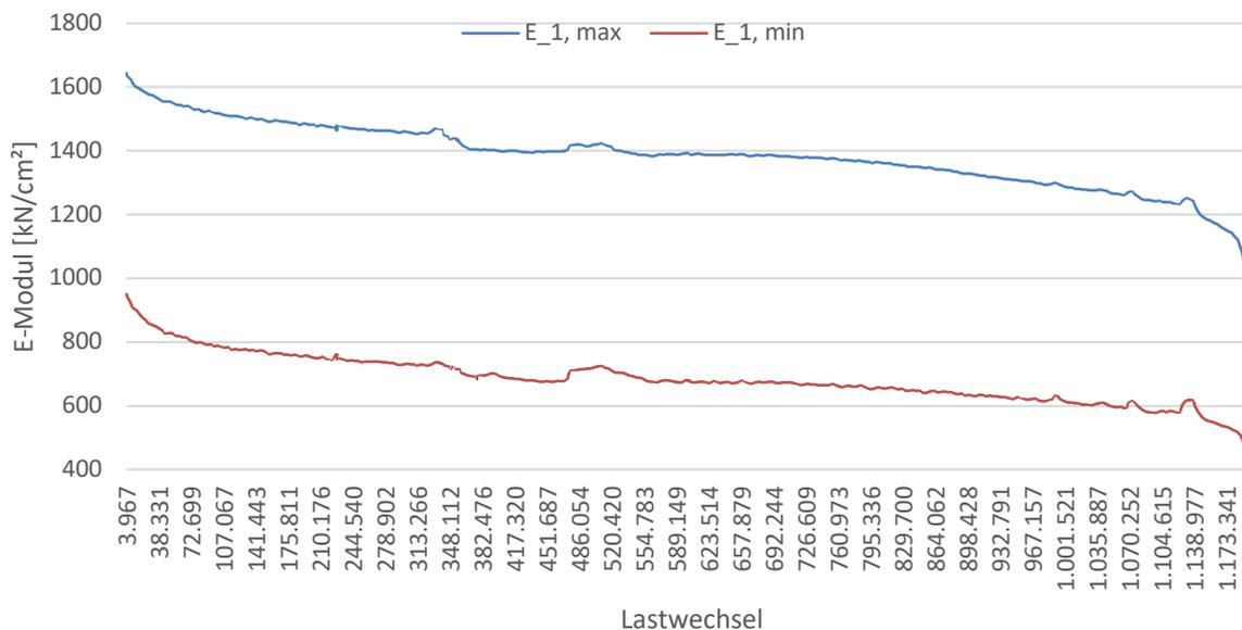
Abb. 4.5: Verlauf des E-Moduls V03 – Wegaufnehmer 1
