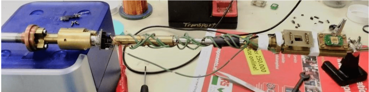
Abbildung E.2: Probenstab des ^3\text{He} -Kryostaten (Erläuterung der Abschnitte siehe untere Aufzählung).
