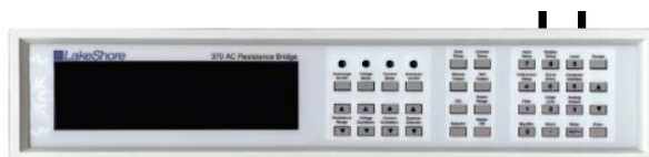
Abbildung 4.3: AC-Resistance-Bridge LAKE SHORE Modell 370 (Frontansicht).
