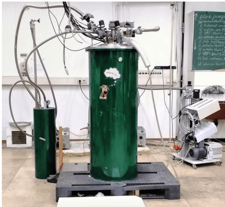
Abbildung 4.4: ^3\text{He} -Kryostat (Mitte) mit ^3\text{He} -Dewar (links) und Vakuumpumpen (rechts beziehungsweise im Hintergrund).
