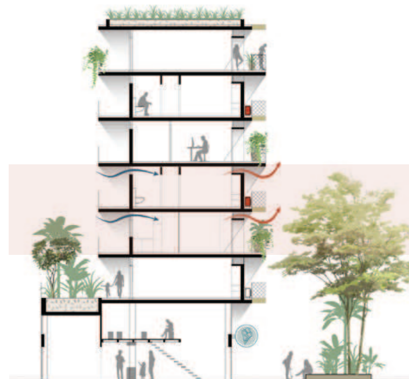
Abb. 180 - Schnitt Wohnquartier, Querlüftung M 1:250 [PS, 2020]
