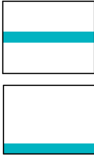
Abb. 20: Erschließungstyp: Innen- gang (oben) und Laubengang (unten)
