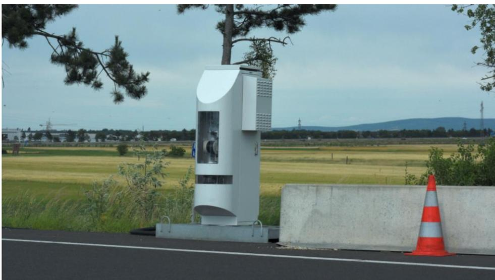
Abbildung 5.19: Mobile Section Control zur Überwachung von Gefahrensituationen. Quelle: Hammel, et al., 2018
