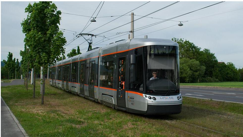
Abbildung 4.57: Eigener Gleiskörper als Rasengleis ausgeführt. Linz. Quelle: PRO BIM GRAZ, 2013
