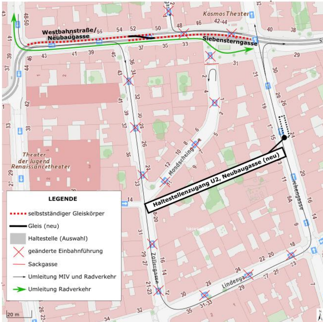
Abbildung 5.33: Wendemöglichkeit zwischen den Haltestellen Westbahnstraße/Neubaugasse und Siebensterngasse mit erforderlicher Umleitung für MIV und Radverkehr
