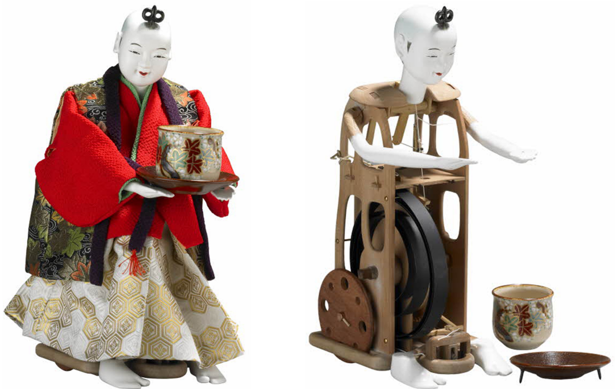
Abbildung 1.1: Karakuri Teeautomat: links bekleidet und rechts der offengelegte Mechanismus, ca. 1800[1]
