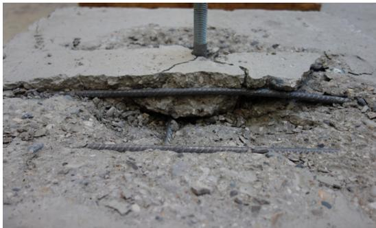
(c) Versuchskörper nach Entfernen loser Betonstücke
