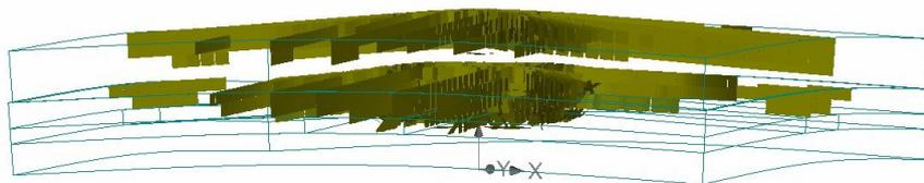
Abb. 4.46: VR5 Schritt 24: Risse ab 0,05 mm
