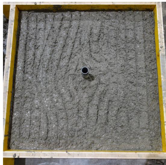
(b) Aufgeraute Betonschicht nach Einbringen der Fertigteilschicht
