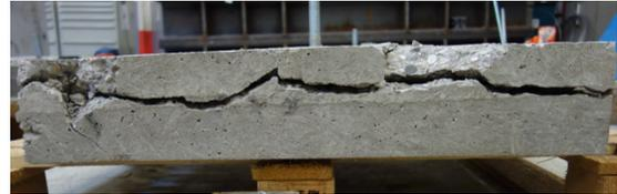
(b) Riss zwischen den Betonschichten
