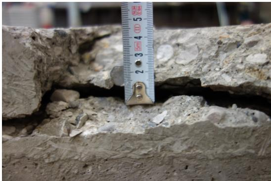
(c) Messung des Risses zwischen den Betonschichten
