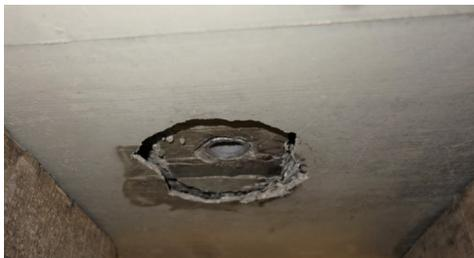
(c) Unterseite des Versuchskörpers nach Entfernen der Lasteinleitungsplatte
