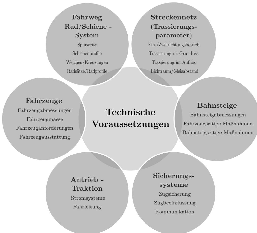
**Abb. 2.1:** Übersicht der technischen Voraussetzungen für den Zweisystembetrieb; in Anlehnung an Nendwich (Nendwich, 2008)
