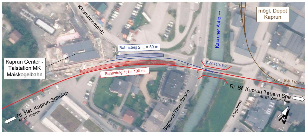
Abb. 5.4: Lageplan der Varianten der Hst. bzw. des Bf. Kaprun Center (M = 1:2000)
