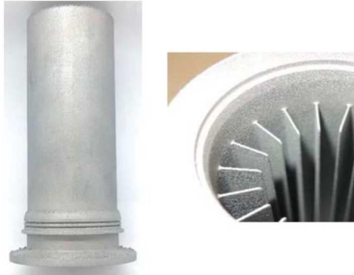
Abbildung 4.8: 3D gedruckte Patrone, links: Außenansicht, rechts: innenliegende Finnen
