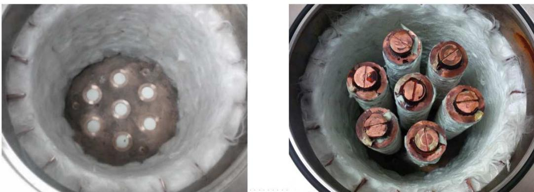
Abbildung 3.17: Komposit im Reaktor, links: ohne Trägerstäbe, rechts: mit vollständig eingebauten Trägerstäben. [73]
