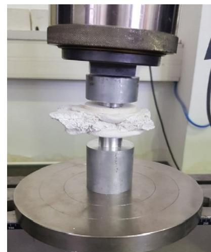
Abb. 17 Belastung der Stempelprobe (DA SW 2018)
