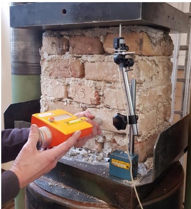
Abb. 26 Prüfung eines belasteten Pfeilers mit dem Rückprallhammer (S.Wallner 2018).
