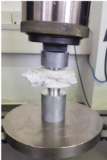
Abb. 30 Prüfung der Druckfestigkeit an erstelltem Stempel
