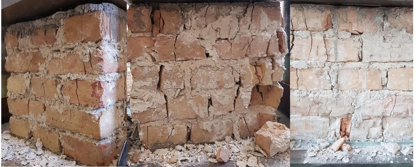
Abb. 42 Erreichen der max. Bruchlast an Pfeiler K1.1 links, K2.1 Mitte, K3.2 rechts.
