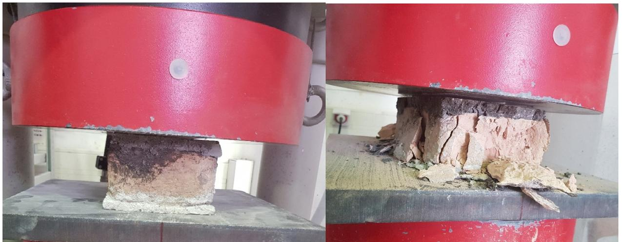
Abb. 35 Druckfestigkeitsmessung an den Ziegeln 25.6.2018
