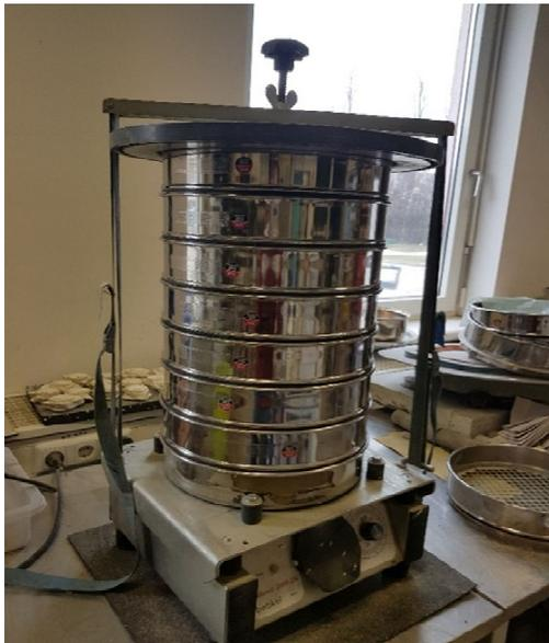
Abb. 1 Korn­größen­verteilung anhand Trockensiebung; Bestimmung der Sieblinie im Labor anhand eines Siebturms; S. Wallner 2018
