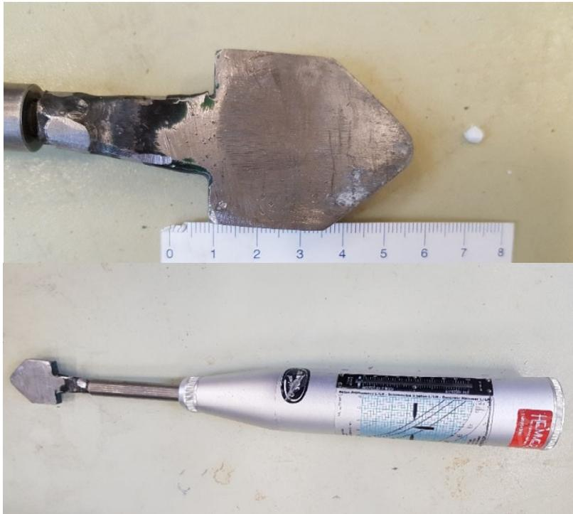
Abb. 33 Schmiehdammer mit der modifizierten Schneide
