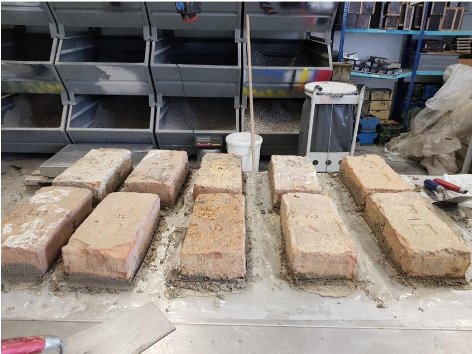
Abb. 23 Abgleichen der Lagerflächen mit dem Zementmörtel DA S.Wallner 2018
