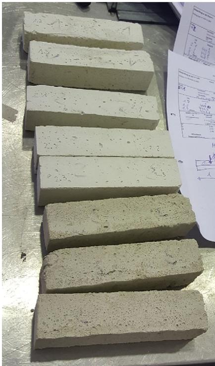
Abb. 4 Fertige Proben für die Biegezugversuche (3 Stk. pro Mörtelart) erstellt im Labor TU Wien, DA Sylwia Wallner 2018
