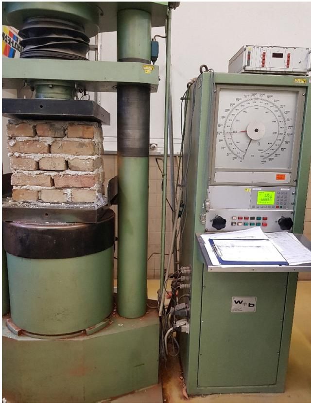
Abb. 40 Druckfestigkeitsprüfung an Pfeiler K1.1 (31.1.2018)
