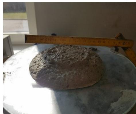
Abb. 3 Ausbreitmaßmessung im TU Labor
