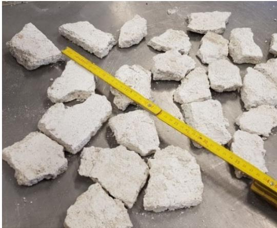
Abb. 14 Ausgestemte vom Mauerwerk Mörtelblättchen (DA SW 2018)
