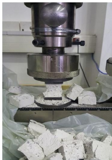
Abb. 9 Zerstörung der Probe (DA Sylwia Wallner 2018)
