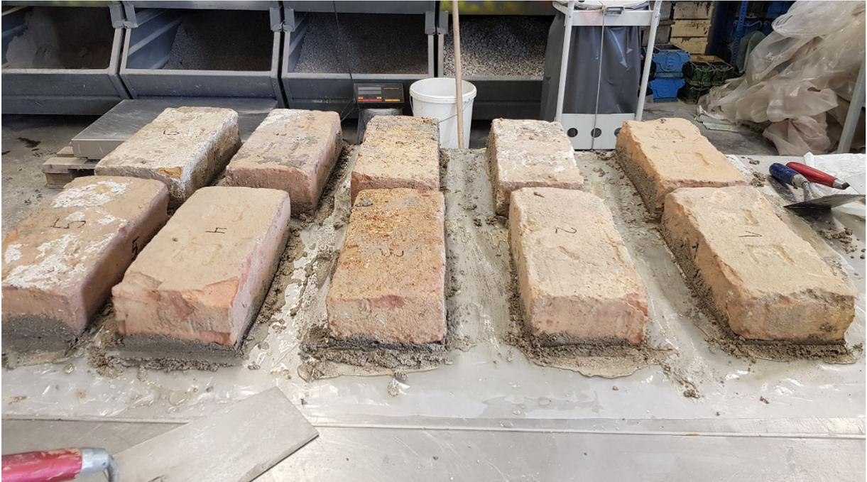
Abb. 34 Abgleichen der Ziegeln mit dem Zementmörtel 16.5.2018
