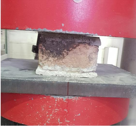
Abb. 24 Druckfestigkeitsprüfung an der Ziegel (TU Labor DA S.Wallner 2018)
