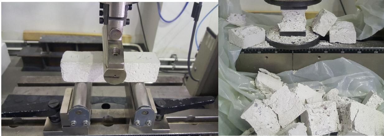
Abb. 29 Mörtelfestigkeitsprüfung an Prismen
