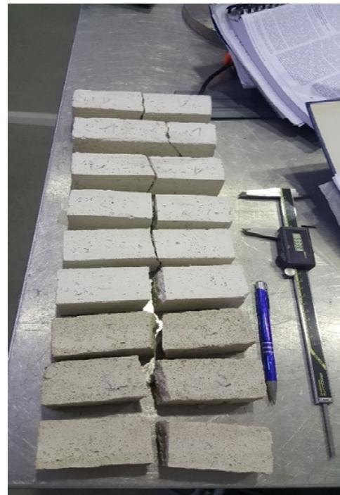
Abb. 5 Fertige Proben (nach dem Biegezugversuch) für die Druckversuche (6 Stk pro Mörtelart) erstellt im Labor TU Wien, DA Sylwia Wallner 2018
