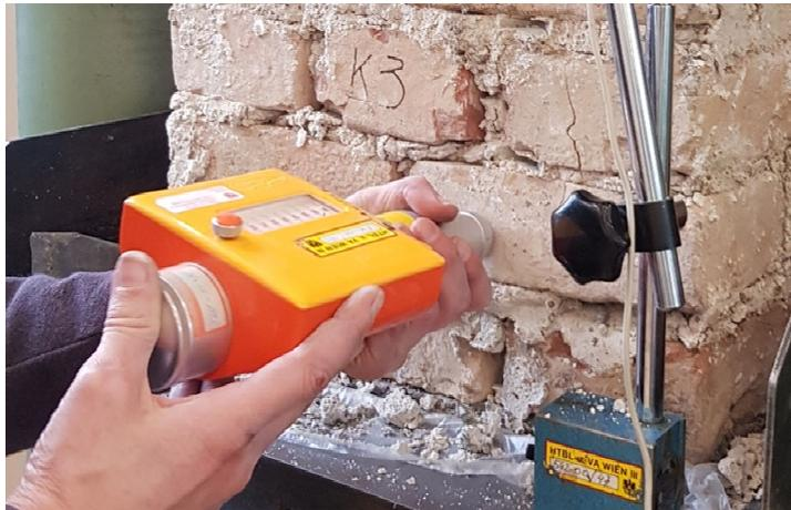
Als erstes wurden die Pfeiler mit dem Mörtel K1 mit dem Alter von 65 Tagen geprüft. Pfeiler mit dem Mörtel K2 und K3 wurden anschließend mit dem Alter von 65 und 50 Tagen geprüft. Die einzelnen Rückprallwerte für alle drei Pfeiler enthält der Anhang 3. Die mittleren Rückprallhärten für die Mauersteine  $f_{Ru}$  sind in Tabelle 26 erfasst. Dabei entspricht die Last von 150kN  $\Rightarrow 1,1\text{N/mm}^2$ , und die Last von 300kN  $\Rightarrow 2,35\text{ N/mm}^2$  Druckspannung.
