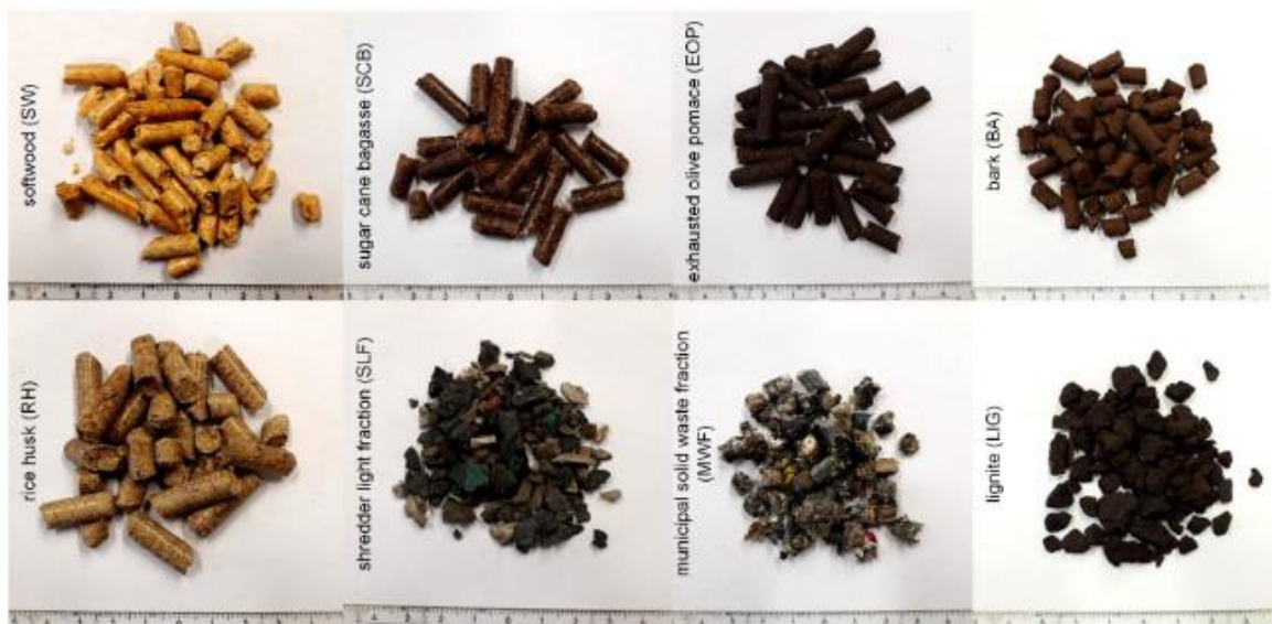
Abbildung 14: Verschiedene Brennstoffe für die Versuche an der 100 kW th Pilotanlage der TU Wien [33]
