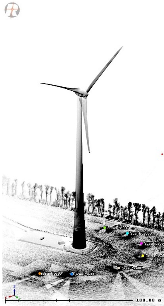
Abbildung 3.2: Darstellung des Laserscans der Windkraftanlage in RiSCAN PRO mit Scannerpositionen
