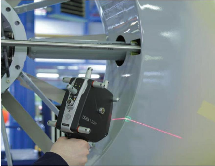
**Abbildung 24:** Beispiel einer Oberflächenvermessung mit dem berührungslosen mobilen Messkopfsystem Leica T-Scan [18]
