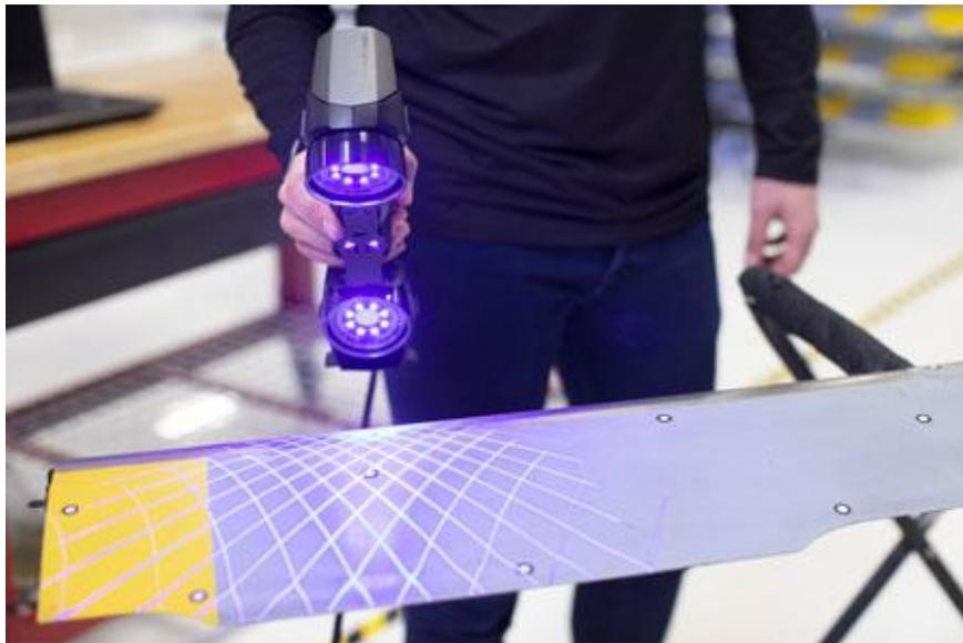
**Abbildung 4:** 3D-Oberflächenmessung mittels Lichtschnittverfahren [5]
