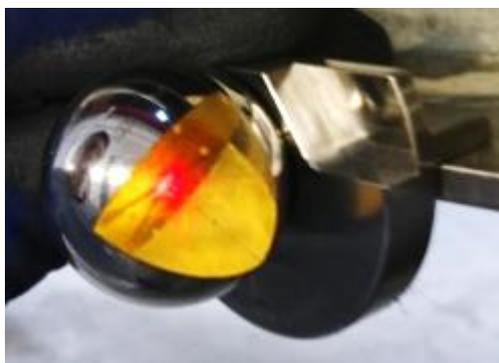
**Abbildung 20:** Beispiel eines Reflektors für Lasertracker (Quelle: Siemens Mobility)
