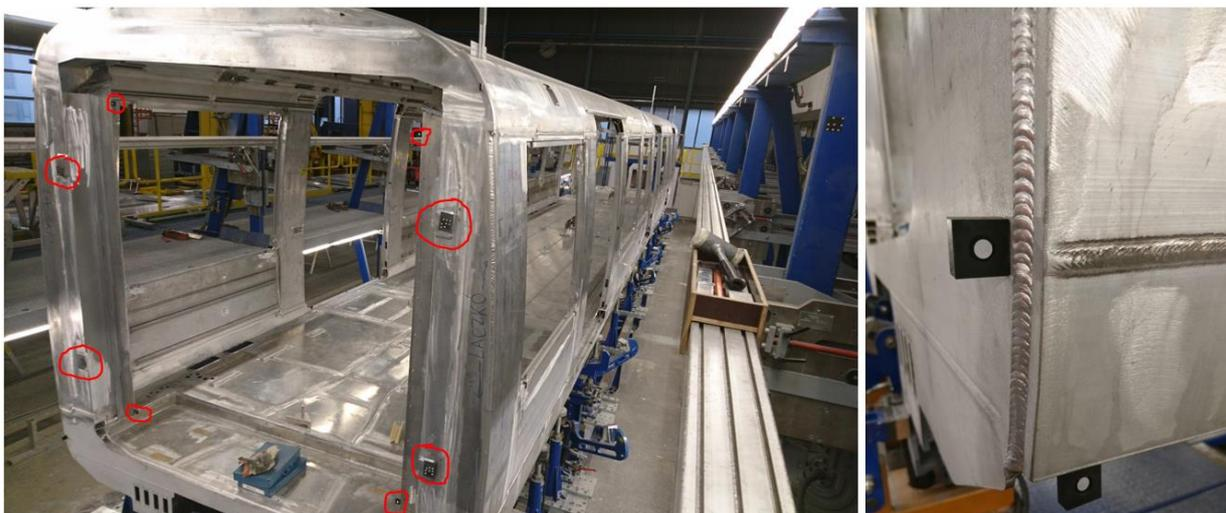
**Abbildung 45:** Referenzmarken zur photogrammetrischen Vermessung (Quelle: Siemens Mobility)
