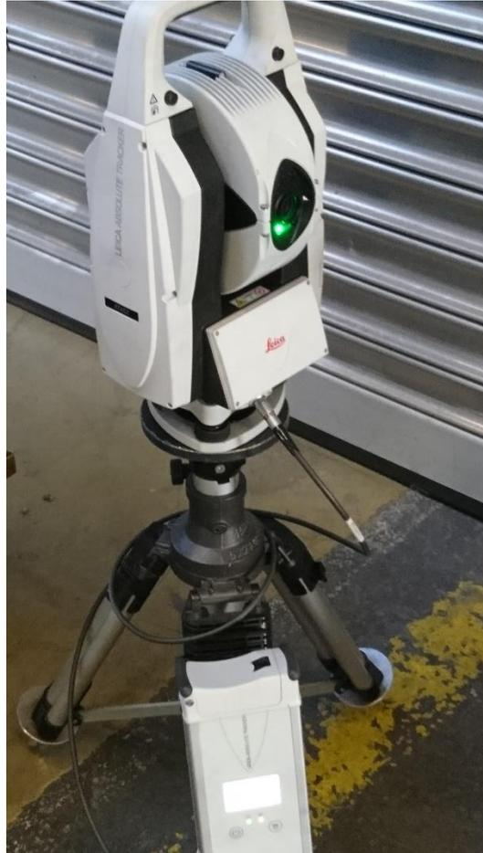
**Abbildung 38:** Leica Absolute Tracker AT 403 (Quelle: Siemens Mobility)
