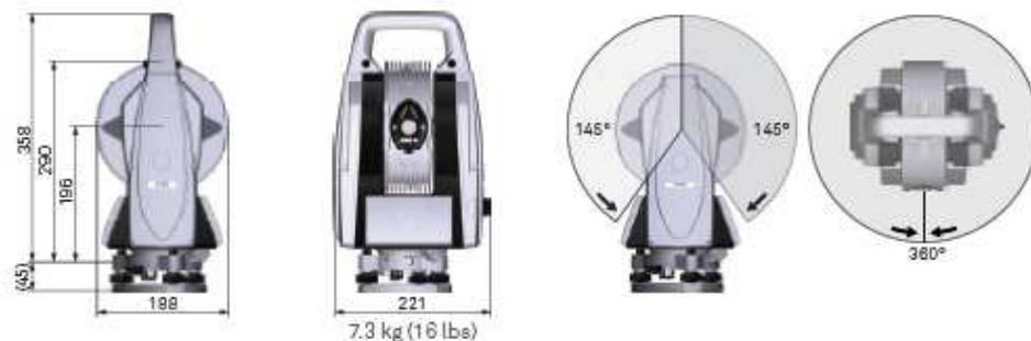
Abbildung 40: Technische Daten des Leica Laser Trackers AT 403 [37]
