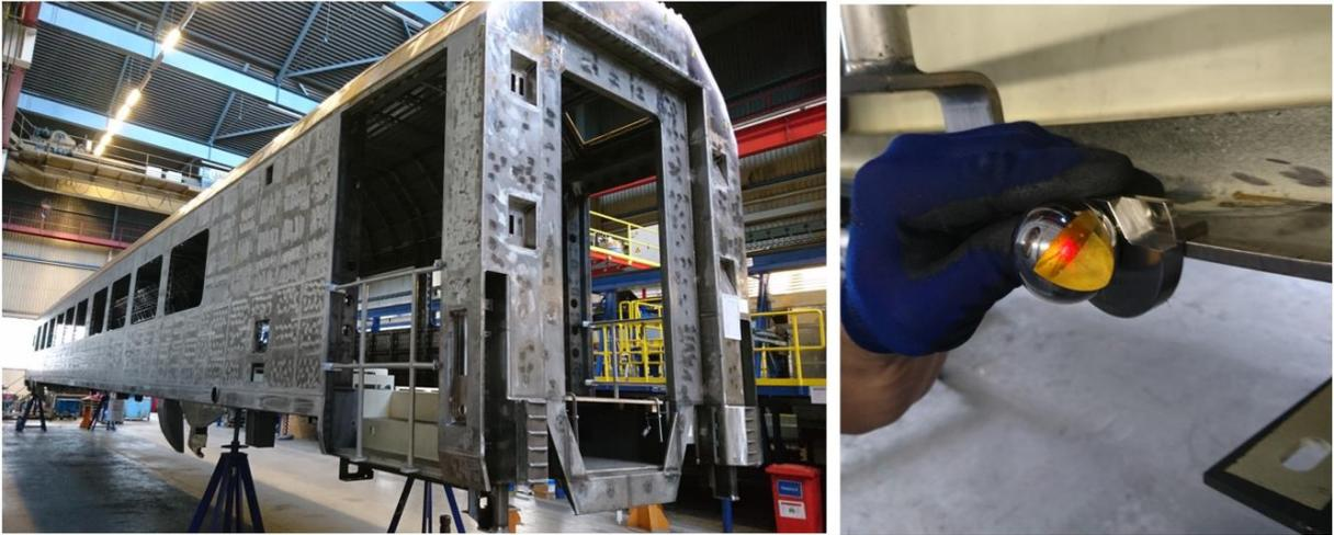
**Abbildung 42:** Messaufbau (links) und Reflektor (rechts) zur Wagenkastenvermessung mittels Laser Tracker (Quelle: Siemens Mobility)
