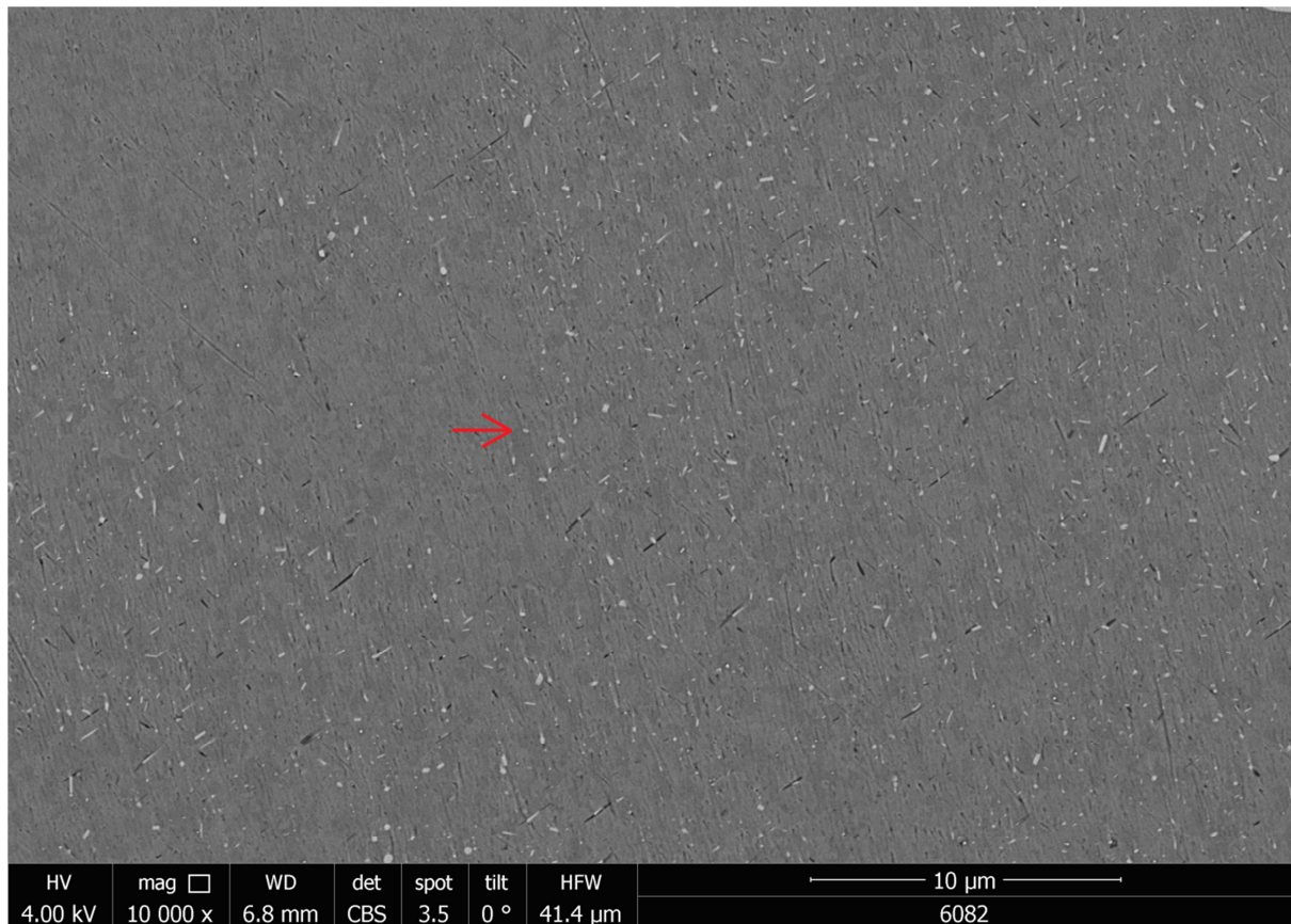
Abbildung 17: SEM-Aufnahme der Probe Hom. Ref_i, die zur Erstellung des Histogramms in Abbildung 18 verwendet wurde; der rote Pfeil markiert ein Dispersoid
