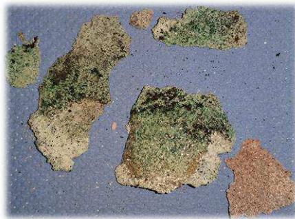
Abbildung 52: chromhaltige Bettmaterialablagerung des Versuchs 16
