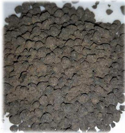
Abbildung 15: Klärschlammgranulat
