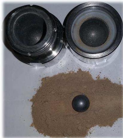
Abbildung 26: Mahlbehälter, -kugel und innenliegende Dichtung der verwendeten Kugelmühle
