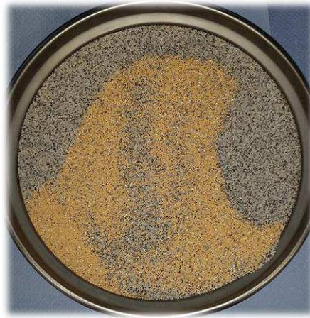
Abbildung 25: Gesiebtes Bettmaterial des Versuches 8 mit Ascherückständen
