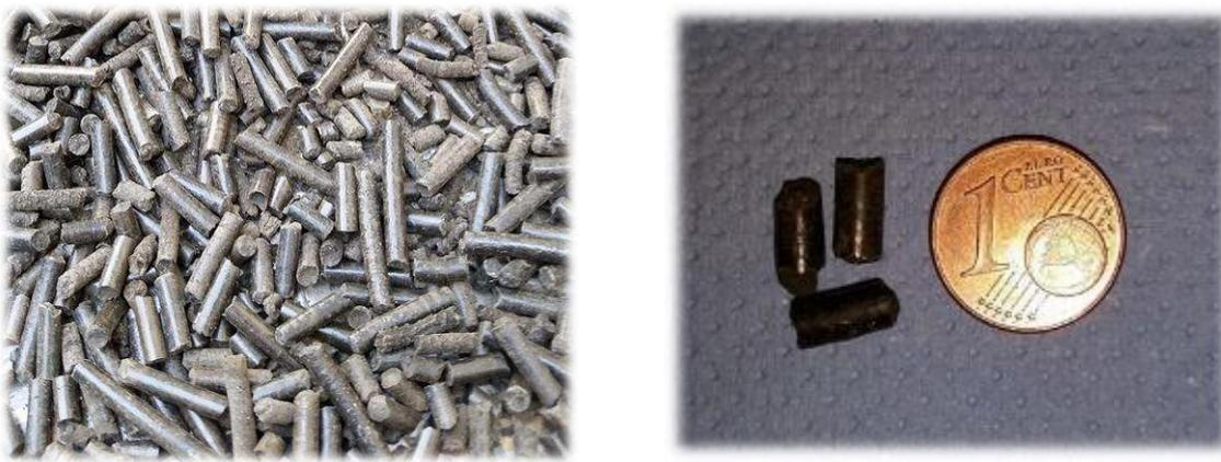
Abbildung 16: Klärschlamm pellets (links); zerkleinerte Pellets nach erfolgter Schneckenförderung (rechts)
