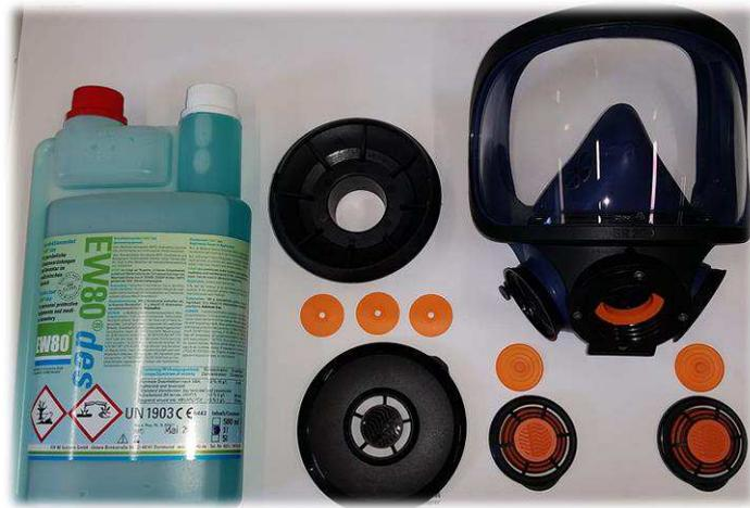
Abbildung 17: Einzelteile der Vollmaske sowie verwendetes Desinfektionsmittel
