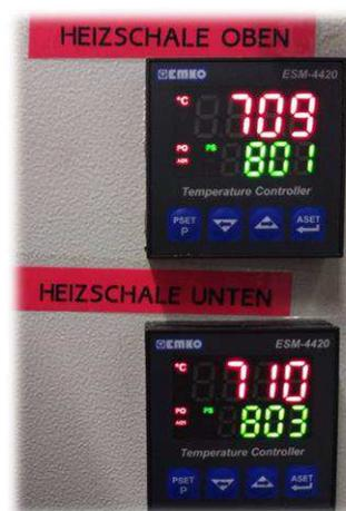
Abbildung 24: Regelung der Heizschalen
