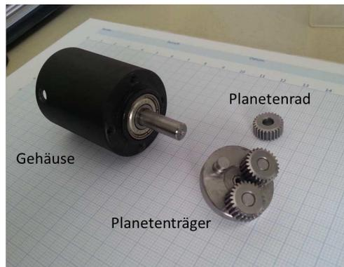
**Abbildung 5.2** Außenansicht des Gehäuses, Planetenträger der 2. Stufe und Planetenzahnräder
