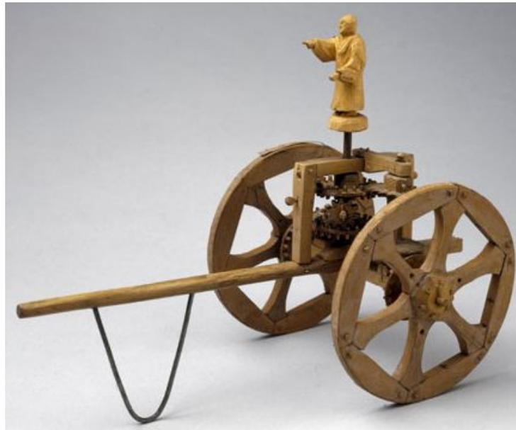
**Abbildung 2.1** Rekonstruktion des Südzeigerwagens aus Holz des Ingenieurs Ma Jun. Das Original ist verloren gegangen [7]
