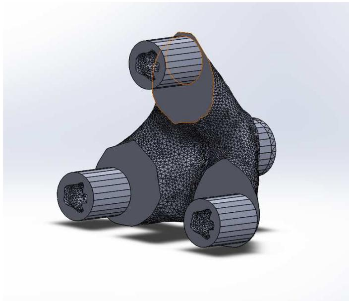
**Abbildung 9.6** Masseoptimierung nach Topologiestudie am Planetenträger mit fiktiven Kräften
