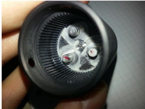
**Abbildung 5.4** Innenansicht des Gehäuses. Sichtbar ist die 1. Stufe des Planetengetriebes und die Fettschmierung als weiße Paste (die zweite Stufe mit Planeten wurde im Bild herausgenommen)
