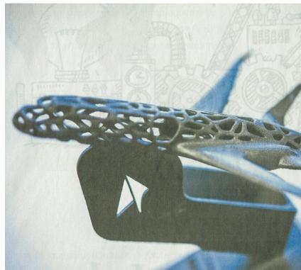
**Abbildung 5.11** Gewichtsoptimierter Flugzeugrumpf 3D-gedruckt. Die organisch aussehende Struktur des Rumpfes spart 30 bis 55 Prozent des Gewichtes ein, während die Kräfte auf den Rumpf immer noch ertragen werden [19]
