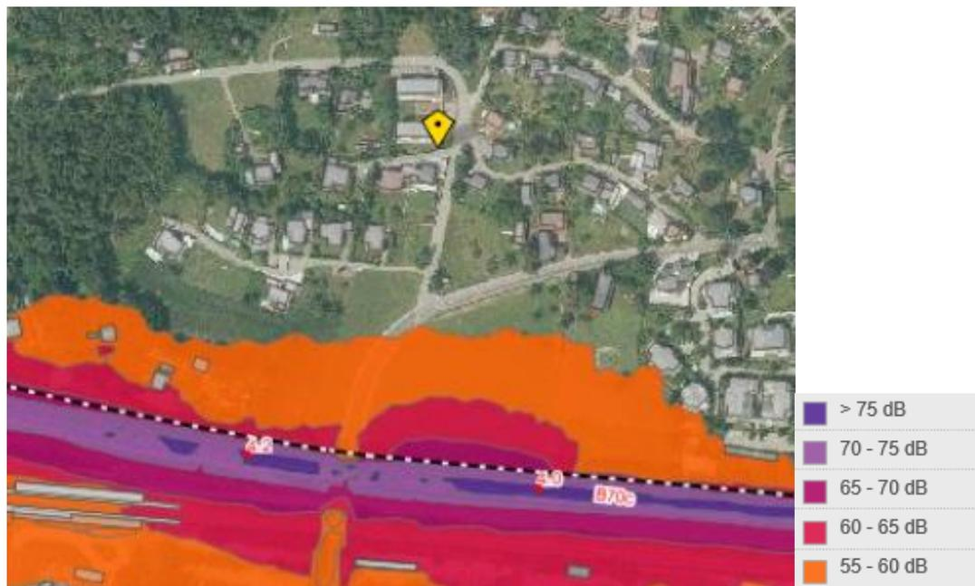
Abb.3.2: Lärmkarte Straßenverkehr 24h-Durchschnitt<sup>24</sup>
