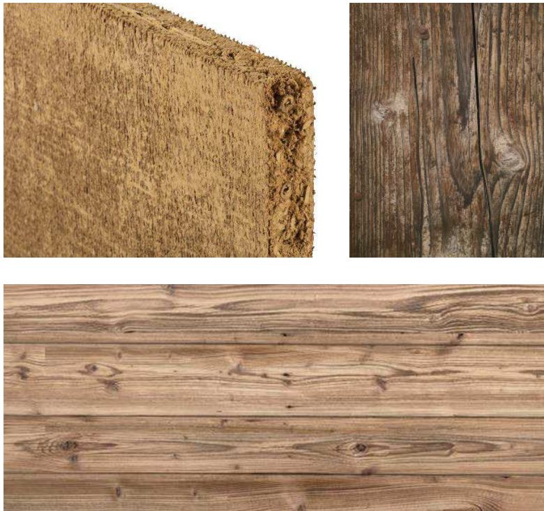
Material: Lehmbauplatten, bestehende Holzelemente, Fichtendielen
