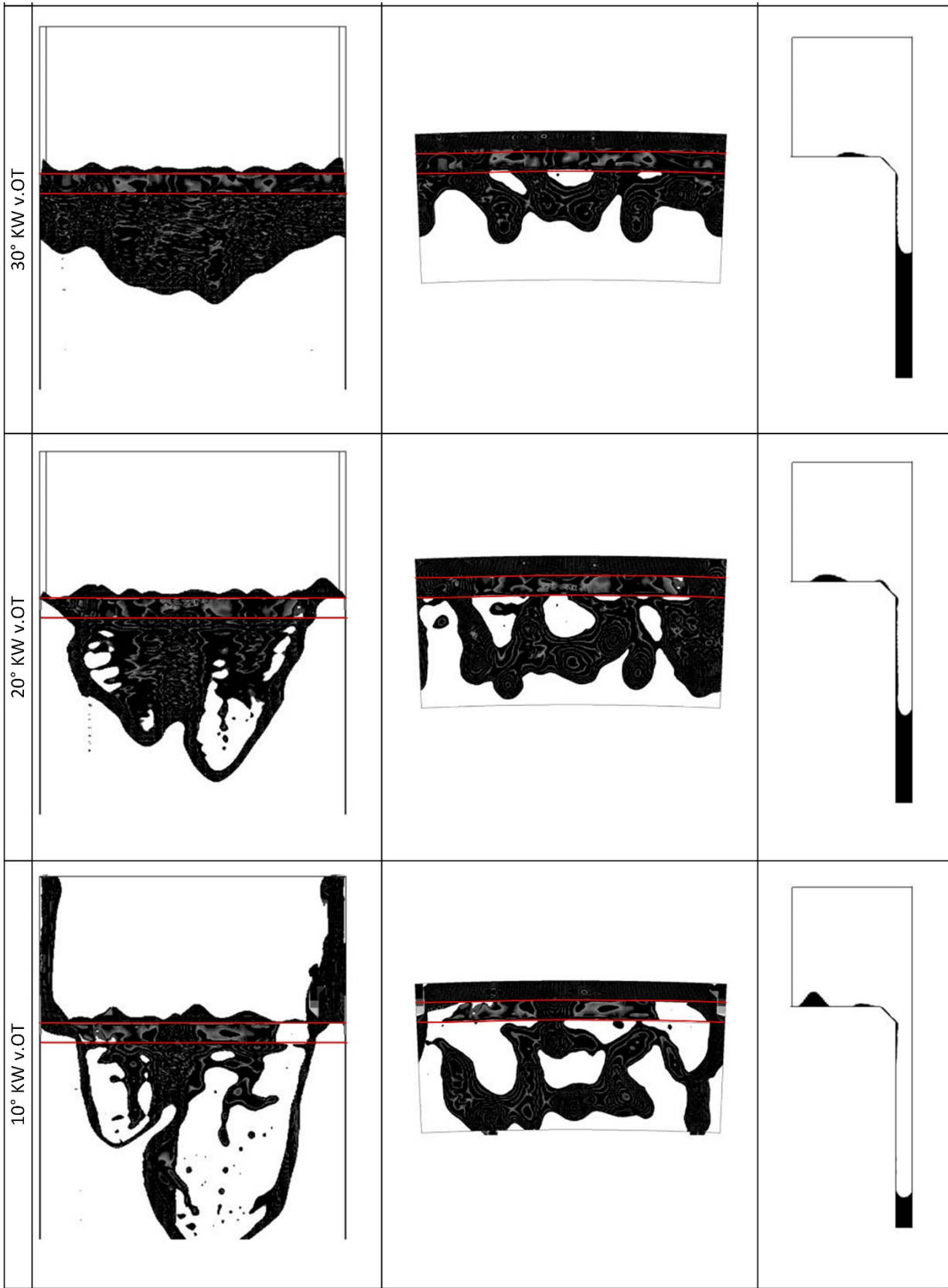
Abbildung 37 Teil 3: Darstellung: 75 % Öl, Kontaktwinkel 20 °, 100 % Füllhöhe. Ansicht Liner – Isosurface, Draufsicht – Isosurface und Schnitt 0.0° Volume Fraction (0 - Flüssigkeit/1 - Luft)
