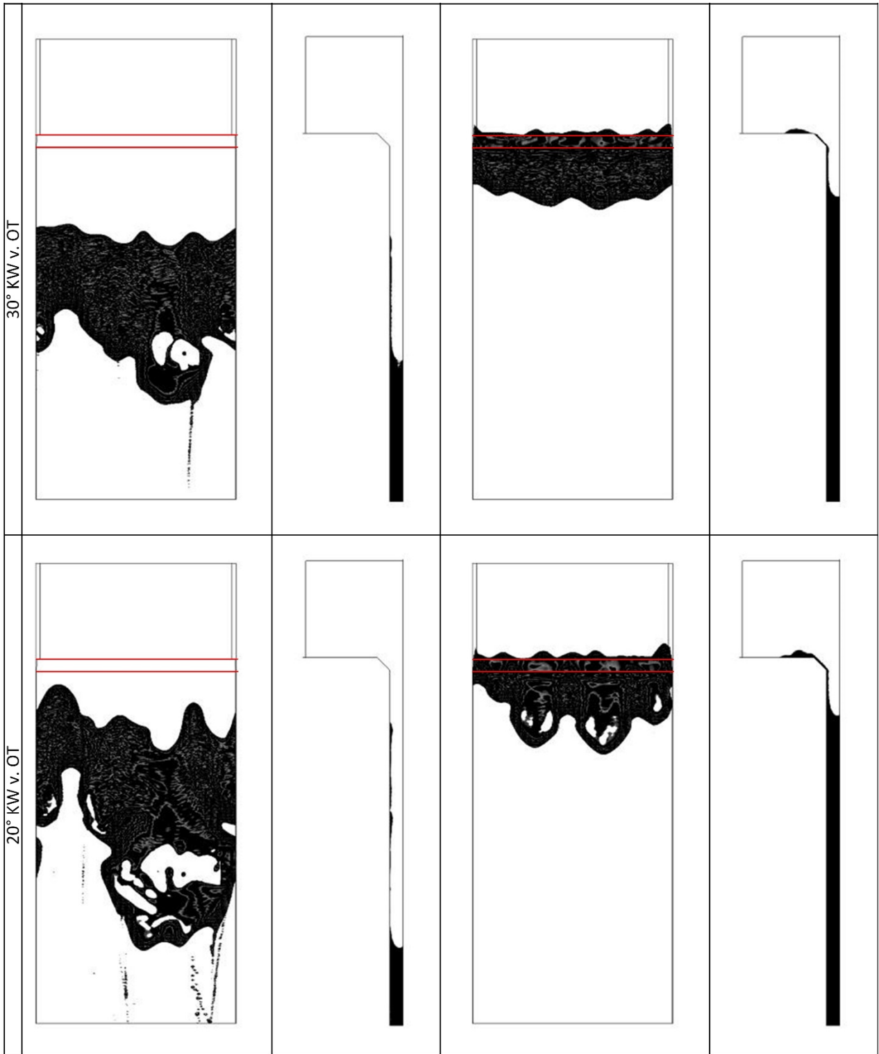
Abbildung 40 Teil 4: Darstellung: 100 % Öl, Kontaktwinkel 20 °, 100 %/50 % Füllhöhe. Ansicht Liner – Isosurface und Schnitt 0.0° Volume Fraction (0 - Flüssigkeit/1 - Luft)
