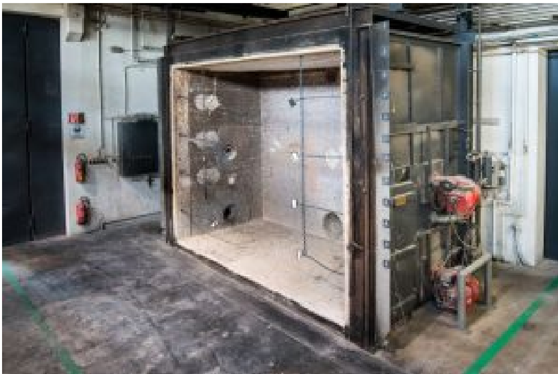
Abbildung 1.2: Ölbefeuerter Vertikalprüfofen nach EN 1363 mit einer beflamnten Fläche von max. 4050 x 3100 mm (BxH)
