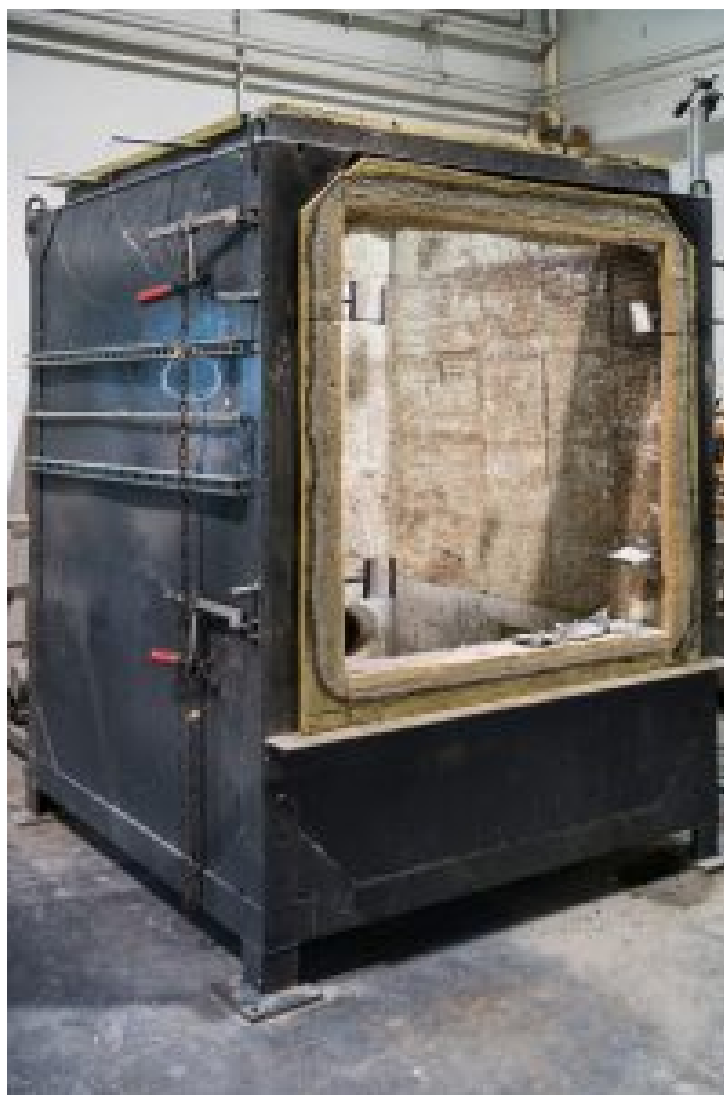
Abbildung 2.3: Gasbefeuert kombinierter Horizontal- und Vertikalprüfstand für orientierende als auch normative Versuche mit einer beflamte Fläche bis max. 1200 x 1200 mm (BxH)
