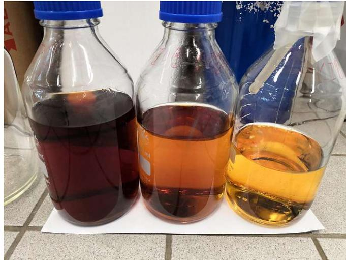
**Abb. 3.17:** Permeate von Membranen mit unterschiedlichem Cut-Off; links: 50 kDa, Mitte: 30 kDa, rechts: 20 kDa
