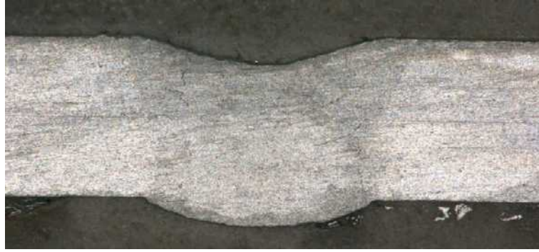
Abbildung 4.13: Schweißnahtoberseite der Probe 55, welche auf einer Aluminiumunterlage geschweißt wurde, Leistung: 900 W, Vorschub: 20 mm/s, Fokusslage: Mitte, Schutzgas: 10 l/Minute, Blechstärke: 1 mm
