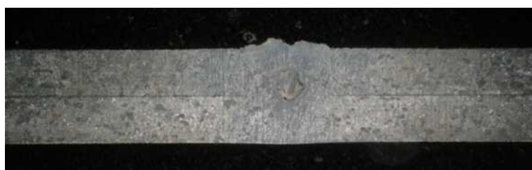
Abbildung 5.17: Querschliff Probe Al-Al 36 Ende, Leistung: 850 W, Vorschub: 20 mm/s, Fokusslage: Mitte, Schutzgas 10 l/Minute, Blechstärke: 1 mm
