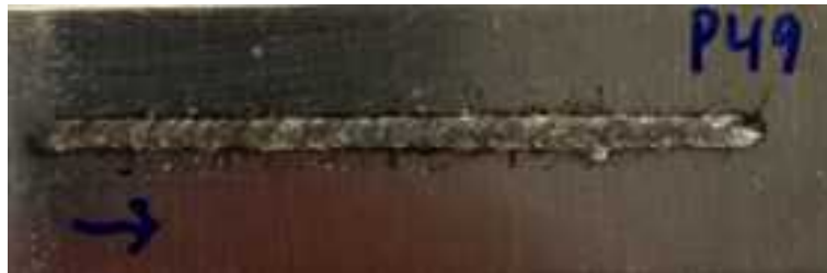
Abbildung 4.6: Probe 49 Aluminium-Aluminium, Leistung: 1200 W, Vorschub: 20 mm/s, Fokuslage: Mitte, Schutzgas: 10 l/Minute, Blechstärke: 1,5 mm
