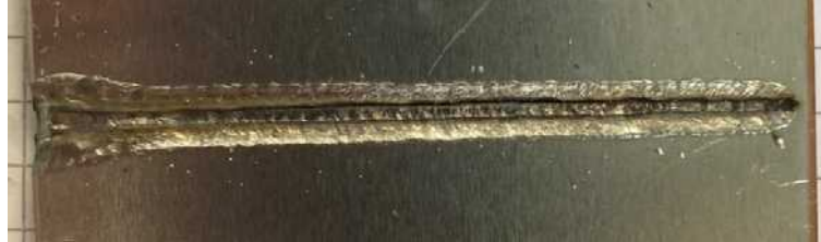
Abbildung 4.30: Probe 93 Nahtoberseite, Leistung: 1200 W, Vorschub: 5 mm/s, Fokussierung: Mitte, Schutzgas: 10 l/Minute, Blechstärke: 1 mm
