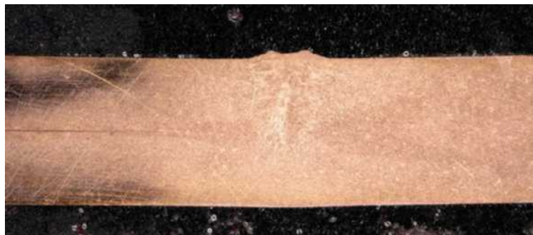
Abbildung 5.23: T4 Mitte, Leistung: 5000 W (60% in Kern, 40% in Ring) 15 %, Vorschub: 150 mm/s, Fokusslage: Oberfläche, Schutzgas: Druckluft, Blechstärke: 1 mm
