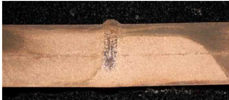
Abbildung 5.22: T1 Ende, Leistung: 5000 W (60% in Kern, 40% in Ring) 15 %, Vorschub: 250 mm/s, Fokusslage: Oberfläche, Schutzgas: Druckluft, Blechstärke: 1 mm
