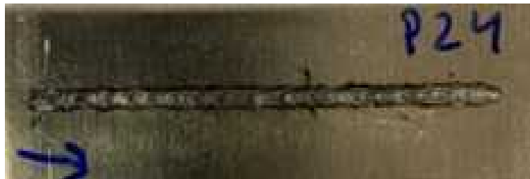
Abbildung 4.16: Probe 24 Aluminium-Kupfer, Leistung: 1300 W, Vorschub: 20 mm/s, Fokusslage: Mitte, Schutzgas: 19 l/Minute, Blechstärke: 1,5 mm
