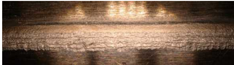
Abbildung 5.39: T 4 Vorderseite Bruchfläche Zugversuch, Leistung: 5000 W (60% in Kern, 40% in Ring) 15 %, Vorschub: 150 mm/s, Fokuslage: Oberfläche, Schutzgas: Druckluft, Blechstärke: 1 mm
