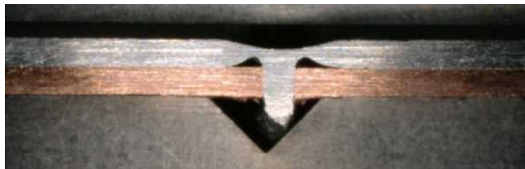
Abbildung 4.29: Probe 93 mit länglicher Pore, Leistung: 1200 W, Vorschub: 5 mm/s, Fokusslage: Mitte, Schutzgas: 10 l/Minute, Blechstärke: 1 mm
