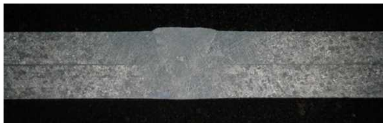
Abbildung 5.16: Querschliff Probe Al-Al 35 Ende, Leistung: 850 W, Vorschub: 20 mm/s, Fokusslage: Mitte, Schutzgas 10 l/Minute, Blechstärke: 1 mm
