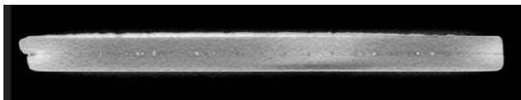
Abbildung 5.12: Cu-Cu T1 Längsschliff, Leistung: 5000 W (60% in Kern , 40% in Ring ) 15 %, Vorschub: 250 mm/s, Fokusslage: Oberfläche, Schutzgas: Druckluft, Blechstärke: 1 mm
