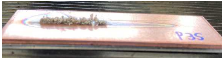
Abbildung 4.31: Probe 35 Aluminiumaustritt Aluminium-Kupfer, Leistung: 1300 W, Fokus auf Mittelebene, Schutzgas: 7 l/Minute, Vorschub: 10 mm/s, Blechstärke: 1,5 mm
