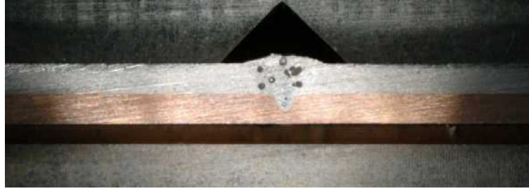
Abbildung 4.34: Probe 83 Querschliff Aluminium-Kupfer-1, Leistung: 1000 W mit Abnahme von 15 %, Fokus auf Mittelebene, Schutzgas: 15 l/Minute, Vorschub: 5 mm/s, Blechstärke: 1 mm
