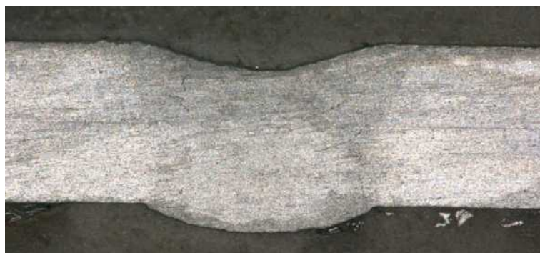
Abbildung 4.4: Probe 55 mit durchgeschweißter Schweißnaht, Leistung: 900 W, Vorschub: 20 mm/s, Fokusslage: Mitte, Schutzgas: 10 l/Minute, Blechstärke: 1 mm
