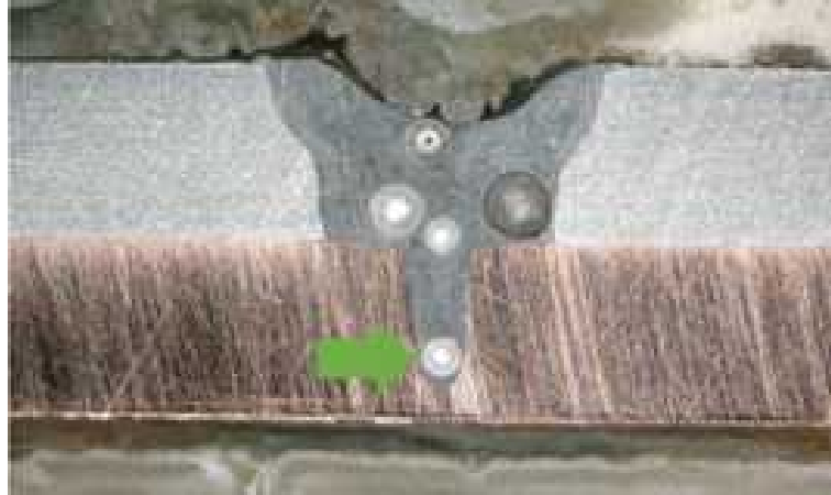
Abbildung 4.28: Probe 33 Querschliff Poren Aluminium-Kupfer, Leistung: 1300 W, Vorschub: 10 mm/s, Fokusslage: Mitte, Schutzgas: 30 l/Minute, Blechstärke: 1,5 mm
