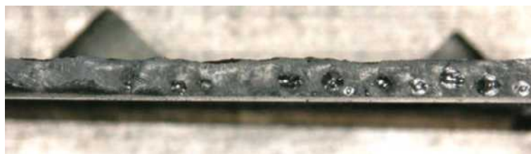
Abbildung 5.31: Al-Cu 28 Bruchfläche Aluminiumbereich neben der Schweißnaht, Leistung: 1000 W mit Abnahme von 15 %, Vorschub: 5 mm/s, Fokusslage: Mitte, Schutzgas: 15 l/Minute, Blechstärke: 1 mm
