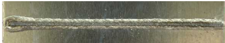
Abbildung 4.33: Probe 83 Nahtoberseite Aluminium-Kupfer, Leistung: 1000 W mit Abnahme von 15 %, Fokus auf Mittelebene, Schutzgas: 15 l/Minute, Vorschub: 5 mm/s, Blechstärke: 1 mm
