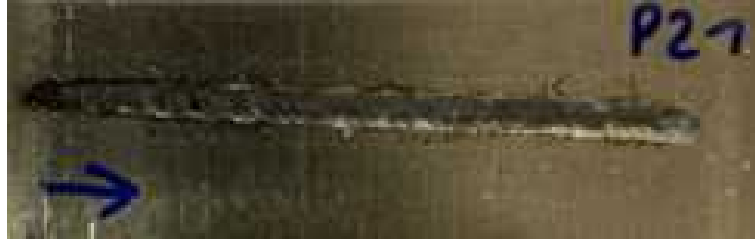
Abbildung 4.17: Probe 21 Aluminium-Kupfer, Leistung: 1300 W, Vorschub: 10 mm/s, Fokusslage: Mitte, Schutzgas: 19 l/Minute, Blechstärke: 1,5 mm
