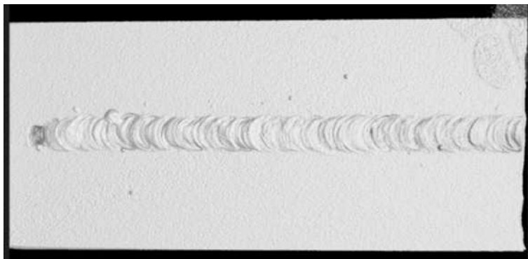
Abbildung 5.4: Al-Al 56 Anfang Oberfläche, Leistung: 850 W, Vorschub: 20 mm/s, Fokusslage: Mitte, Schutzgas: 10 l/Minute, Blechstärke: 1 mm
