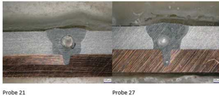
Abbildung 4.15: Querschliffe der Probe 21 und der Probe 27, Leistung: 1300 W/ 1500 W, Vorschub: 00 mm/s, Fokusslage: Mitte, Schutzgas: 19 l/Minute, Blechstärke: 1,5 mm
