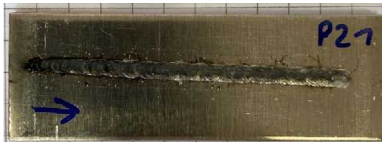
Abbildung 4.20: Fokuslage liegt in der Mittelebene Aluminium-Kupfer, Leistung: 1300 W, Vorschub: 10 mm/s, Fokuslage: Mitte, Schutzgas: 19 l/Minute, Blechstärke: 1,5 mm
