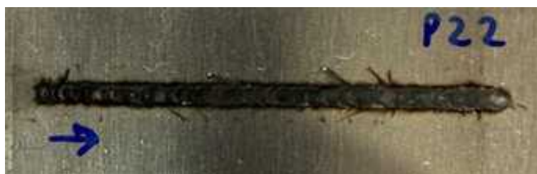
Abbildung 4.21: Fokuslage liegt 0,5mm unterhalb der Mittelebene Aluminium-Kupfer, Leistung: 1300 W, Vorschub: 10 mm/s, Fokuslage: 0,5 unterhalb der Mitte, Schutzgas: 19 l/Minute, Blechstärke: 1,5 mm
