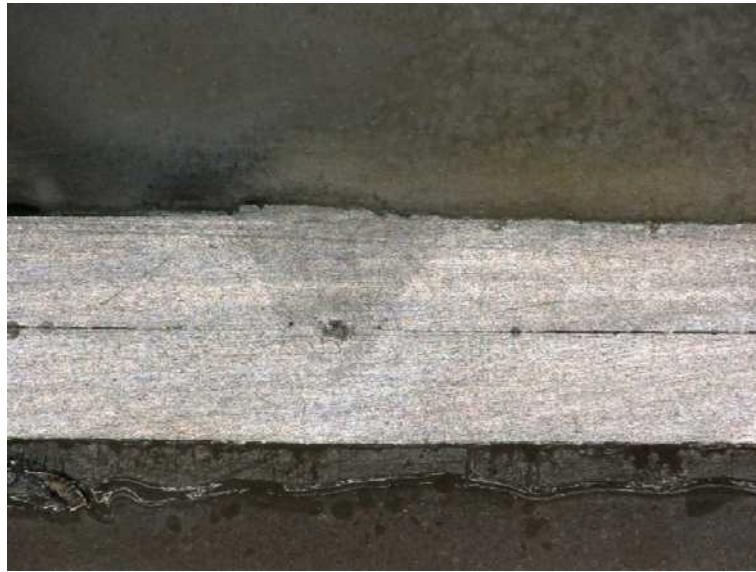
Abbildung 4.12: Schweißnahtoberseite der Probe 50, welche auf einer Stahlunterlage geschweißt wurde, Leistung: 900 W, Vorschub: 20 mm/s, Fokusslage: Mitte, Schutzgas: 10 l/Minute, Blechstärke: 1 mm
