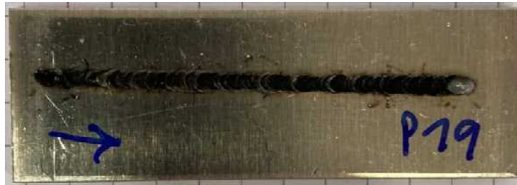
Abbildung 4.19: Fokuslage liegt 1mm oberhalb der Mittelebene Aluminium-Kupfer, Leistung: 1300 W, Vorschub: 10 mm/s, Fokuslage: 1 oberhalb der Mitte, Schutzgas: 19 l/Minute, Blechstärke: 1,5 mm
