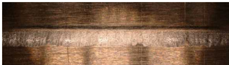
Abbildung 5.35: T 1 Bruchfläche Vorderseite Zugversuch, Leistung: 5000 W (60% in Kern, 40% in Ring) 15 %, Vorschub: 250 mm/s, Fokusslage: Oberfläche, Schutzgas: Druckluft, Blechstärke: 1 mm
