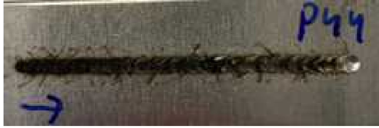
Abbildung 4.5: Probe 44 Aluminium-Aluminium, Leistung: 1000 W, Vorschub: 10 mm/s, Fokuslage: Mitte, Schutzgas: 19 l/Minute, Blechstärke: 1,5 mm
