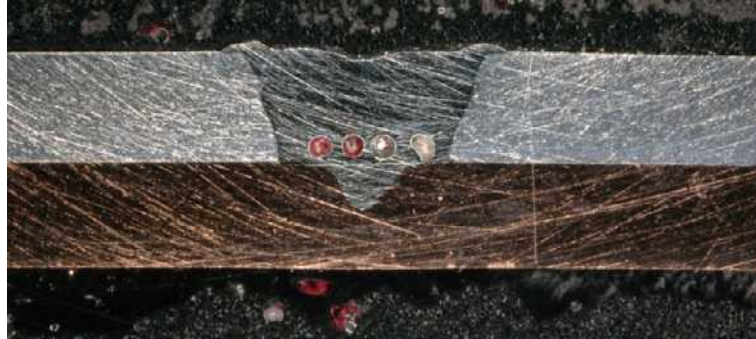
Abbildung 5.19: Querschliff Probe Al-Cu 12 Ende, Leistung: 1000 W mit Abnahme von 15 %, Vorschub: 5 mm/s, Fokusslage: Mitte, Schutzgas 15 l/Minute, Blechstärke: 1 mm
