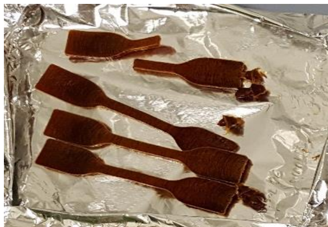
Abb. 5.4: Bestimmung der Schwachstelle der Proben durch Versagen.
