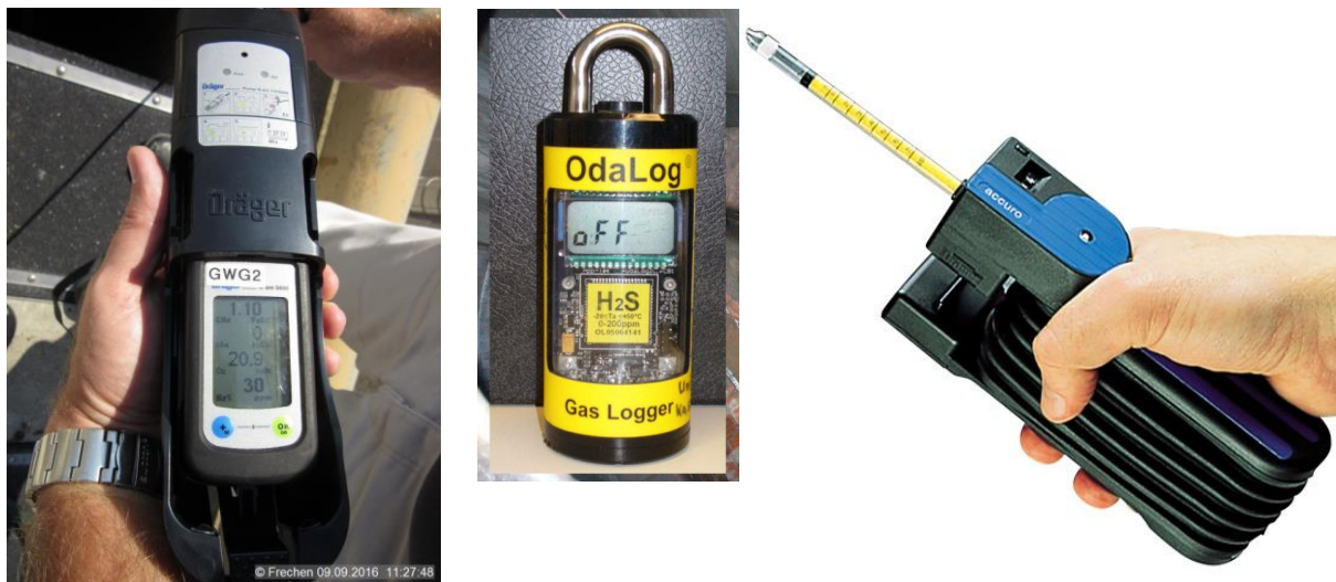
Abbildung 2: Einfache analytische Messgeräte (links elektrochemisches Handmessgerät mittig elektrochemisch mit Datenspeicher für Kanaleinsatz, rechts Prüfröhrchen)
