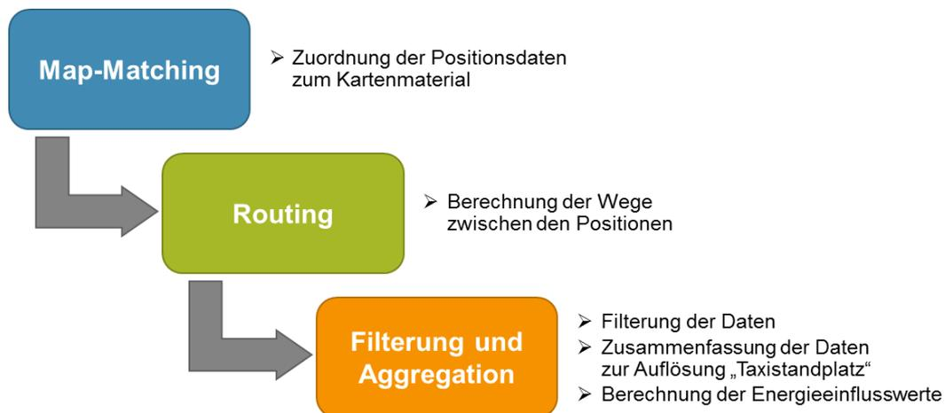
Abbildung 3-2: Funktionen des Floating-Car-Servers zur Aufbereitung der Mobilitätsdaten
