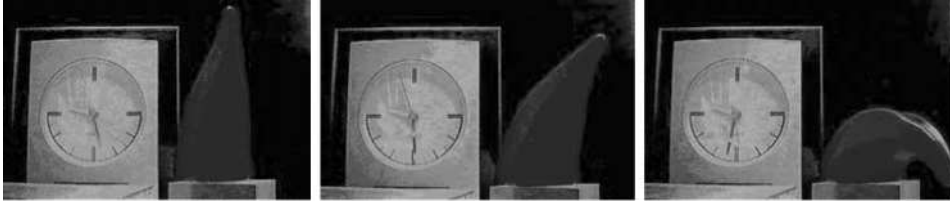
Abbildung 2.1. Verhalten einer viskoelastischen Pyramide mit zunehmender Zeit [9]
