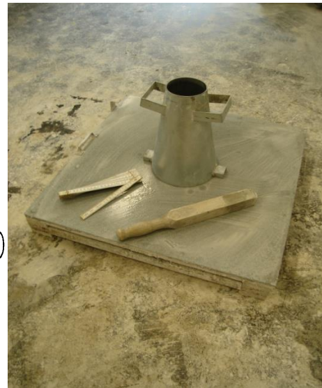
Abbildung 2-4: Geräte zur Ausbreitmaßbestimmung (Schneider, S.60 /2/)
