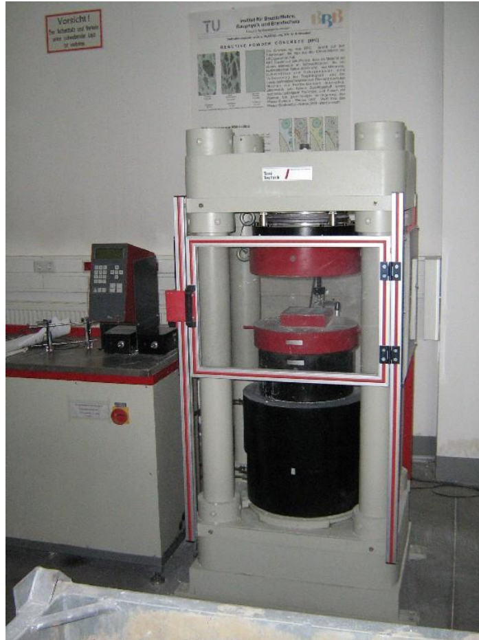
Abbildung 3-28: Gerät zur Überprüfung der Druckfestigkeit bei Würfel
