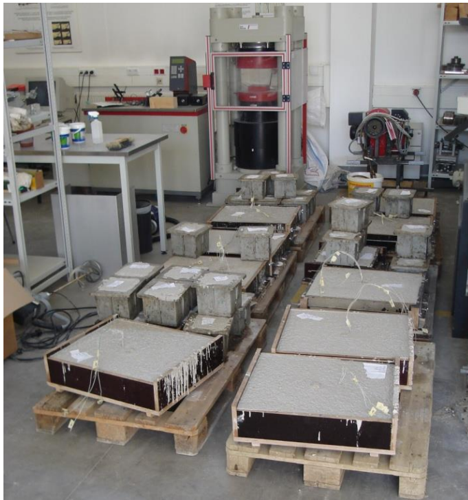
Abbildung 3-18: Lagerung der betonierten Versuchskörper
