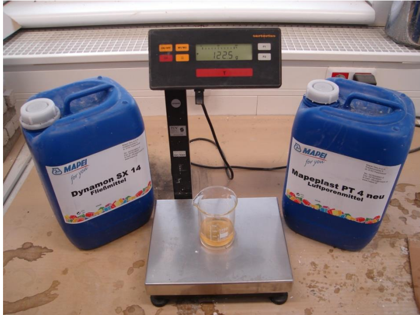
Abbildung 3-14: Feinwaage mit Zusatzmitteln
