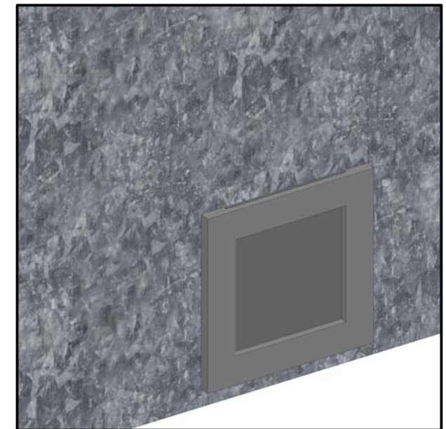
Schritt 7b: Bei aufgeschweißter Einfüllhilfe kann diese gleich als "Deckel" für die Einfüllöffnung verwendet werden. Dazu muss noch der Schieber an der oberseite und innerhalb des "Fensters" umlaufend verschweißt werden.
