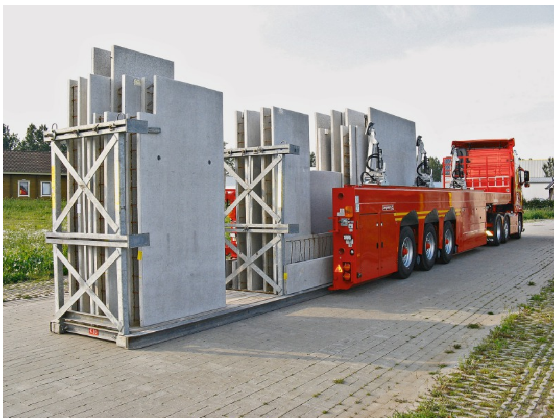
Abb. 2.16: Anwendung Innenlader bei Betonfertigteilen 1
