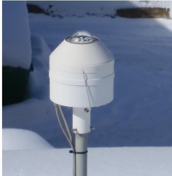
**Abb. 3.23:** Pyranometer (Station Kühtai), eigene Aufnahme
