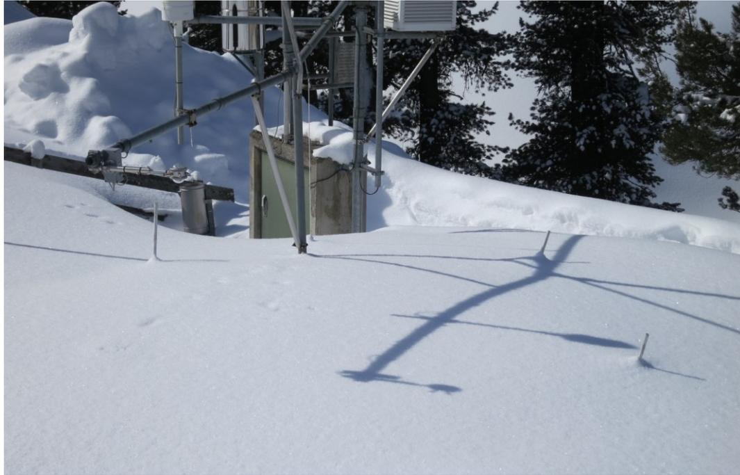
**Abb. 3.28:** Bereich des hexagonalen Schneekissens mit einigen sichtbaren Stangen an den Eckpunkten (Station Kühtal), eigene Aufnahme
