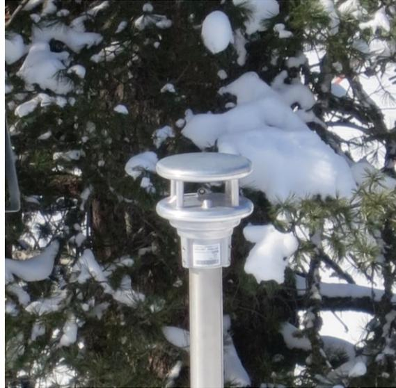
**Abb. 3.26:** Ultraschall-Anemometer zur Erfassung der Windgeschwindigkeit (Station Kühtai), eigene Aufnahme
