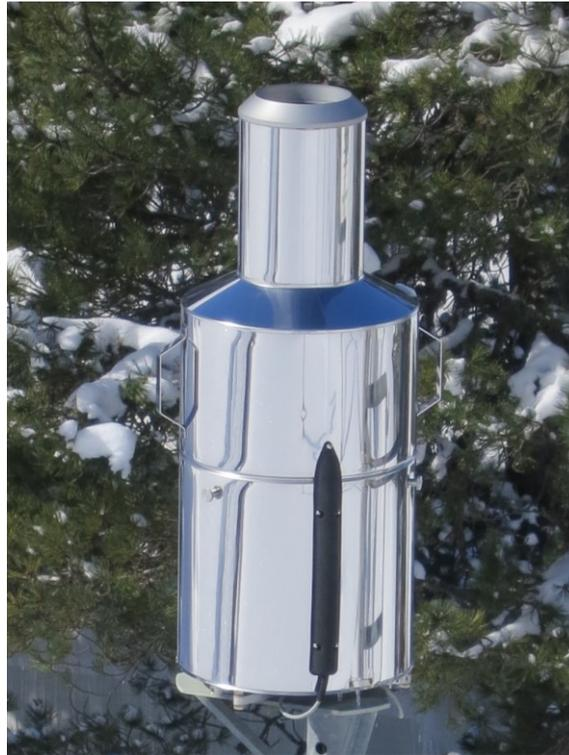
**Abb. 3.27:** Messeinheit zur Niederschlagsmessung (OTT Pluvio, Station Kühtai), eigene Aufnahme
