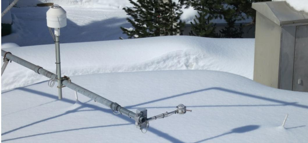
**Abb. 3.22:** Messeinheiten zur Erfassung der einfallenden kurzwelligen Strahlung (li. auf vertikaler Stange) und der reflektierten kurzwelligen Strahlung (re. an horizontalem Stabende) an der Station Kühtai, eigene Aufnahme
