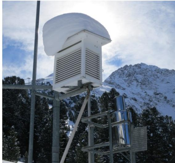
**Abb. 3.19:** Wetterhäuschen mit Lufttemperatur- und Luftfeuchtigkeitssensor (Station Kühtai), eigene Aufnahme
