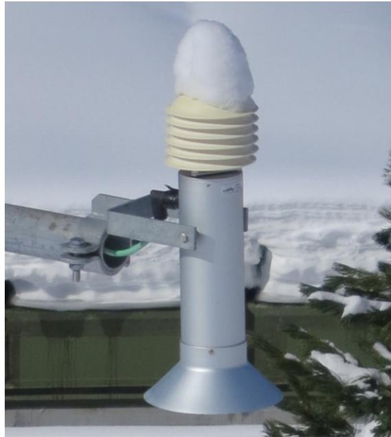
**Abb. 3.29:** Ultraschallsensor zur Schneehöhenmessung (Station Kühtai), eigene Aufnahme
