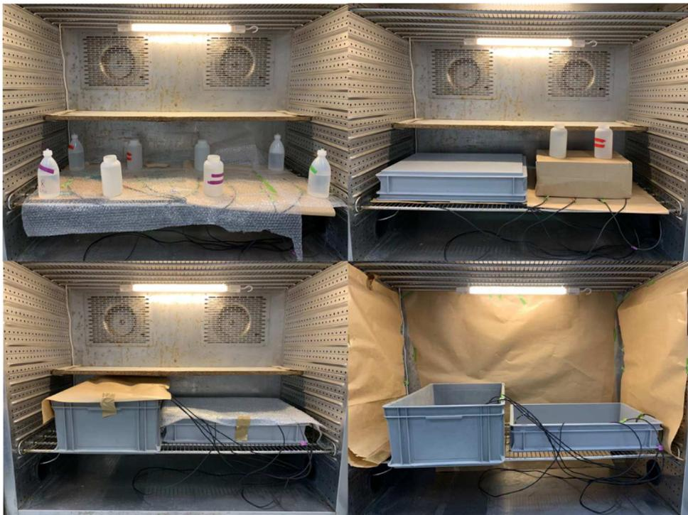
**Abbildung 11 Konstruktive Maßnahmen zur Temperaturvergleichmäßigung**
