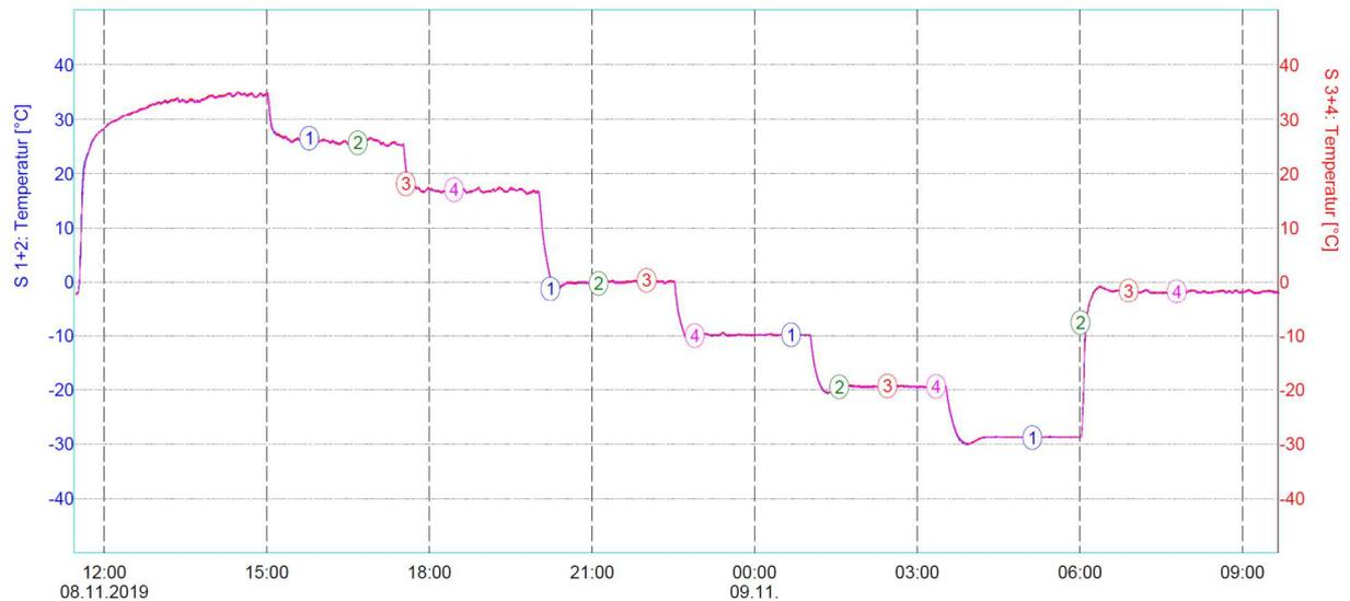
Abbildung 8 Temperaturverlauf Kalibrierung Messung 2-Datenlogger 85942
