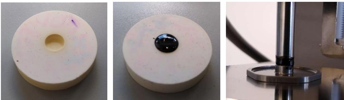
Abbildung 9: Links und Mitte: Silikongussform zur Herstellung zylindrischer Mastixprobekörper (ohne und mit hergestellten Probekörper); Rechts: in DSR eingebauter zylindrischer Probekörper, nach dem Trimmen
