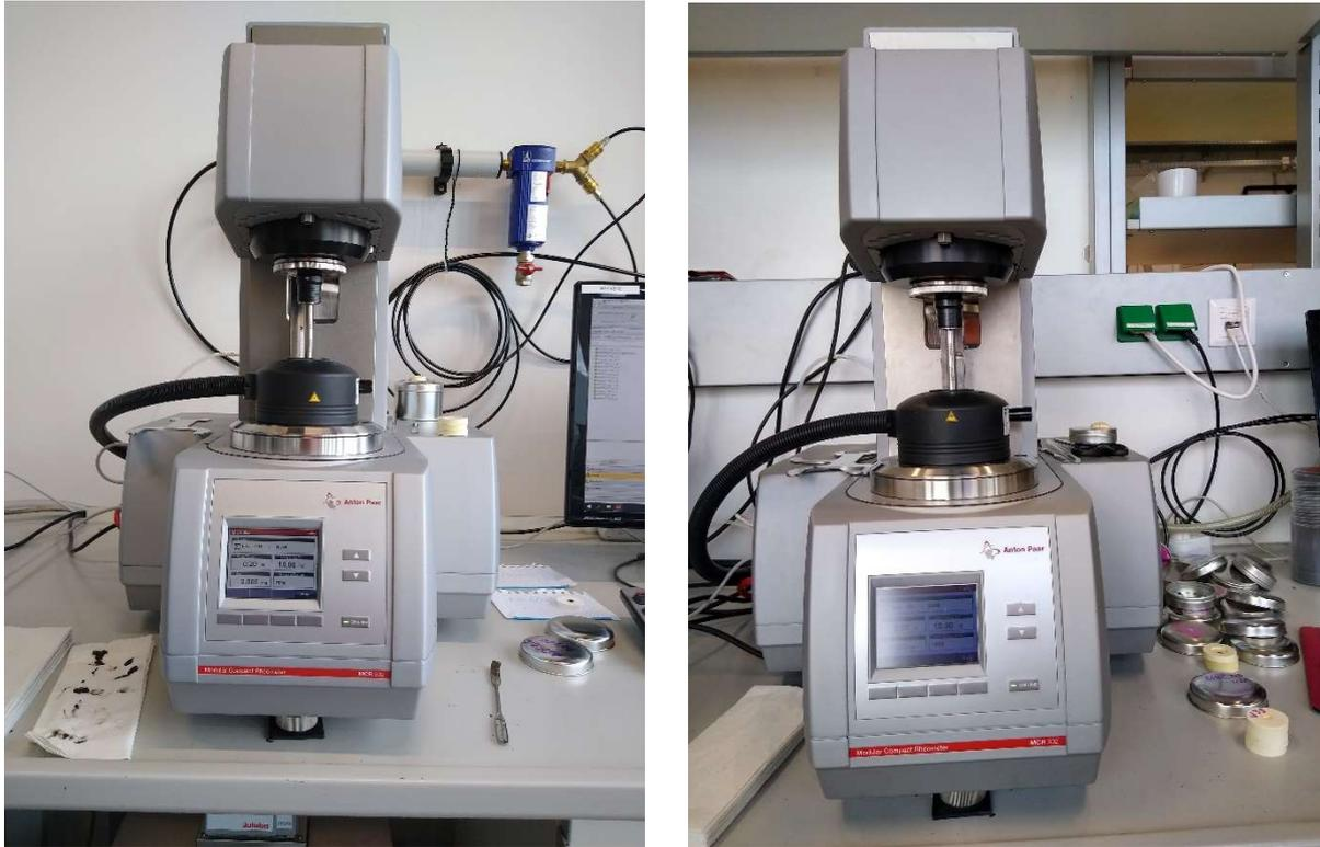
Abbildung 11: Verwendete Messgeräte – Anton Paar MCR302 BJ2012 (links) und Anton Paar MCR302 BJ2019 (rechts)
