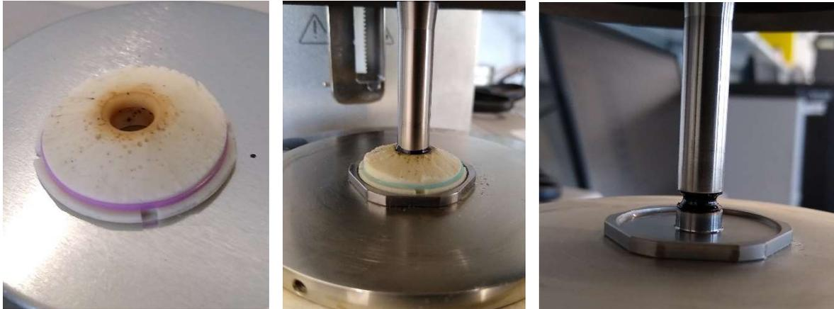
**Abbildung 10:** Links: Silikonform zur Herstellung hyperbolischer Mastixprobekörper; Mitte: Eingebaute Silikonform nach dem Einfüllvorgang; Rechts: in DSR eingebaute hyperbolischer Probekörper, nach Entfernung der Silikonform
