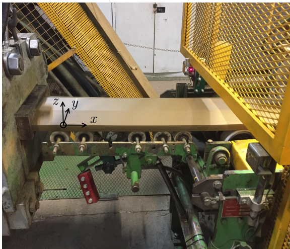
(a) Extrusion einer Ziegelgeometrie im Werk der Fa. Wienerberger
