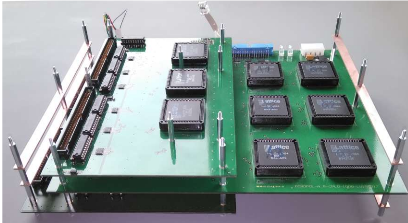
Abbildung 3.2: Foto der übereinander gestapelten Steuerplatinen (Bild aus [10])
