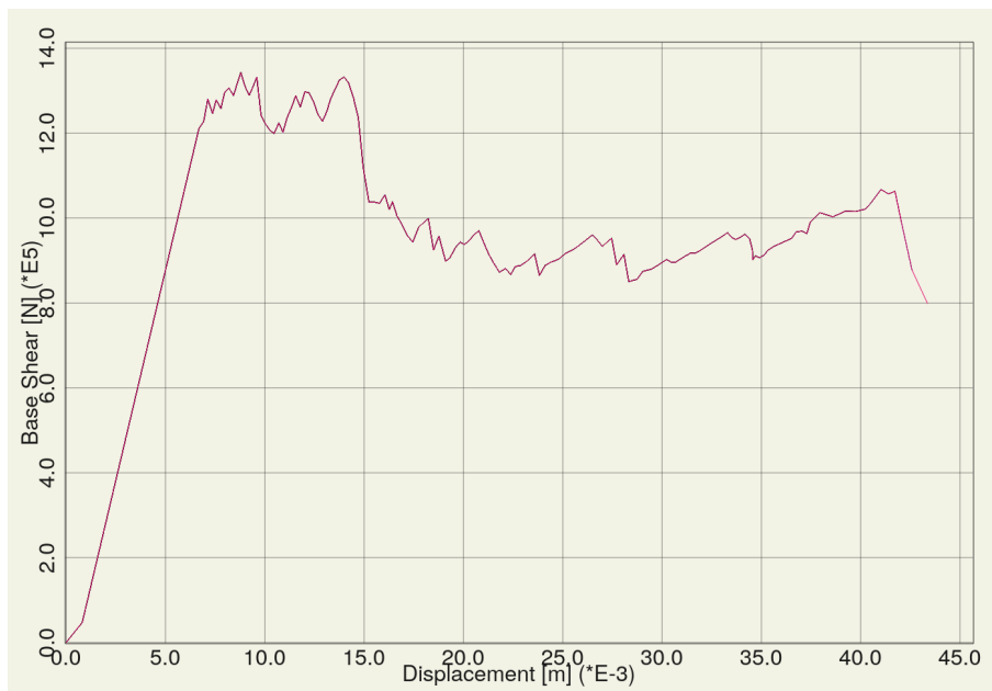
Abb. 6.9: Kapazitätskurve - Pushover-Analyse gemäß zweiter Eigenform
