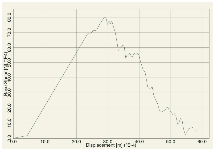
Abb. 6.21: Pushover-Analyse gemäß dritter Eigenform - Basisquerkraft in y-Richtung Q_{b,3,y,R}
