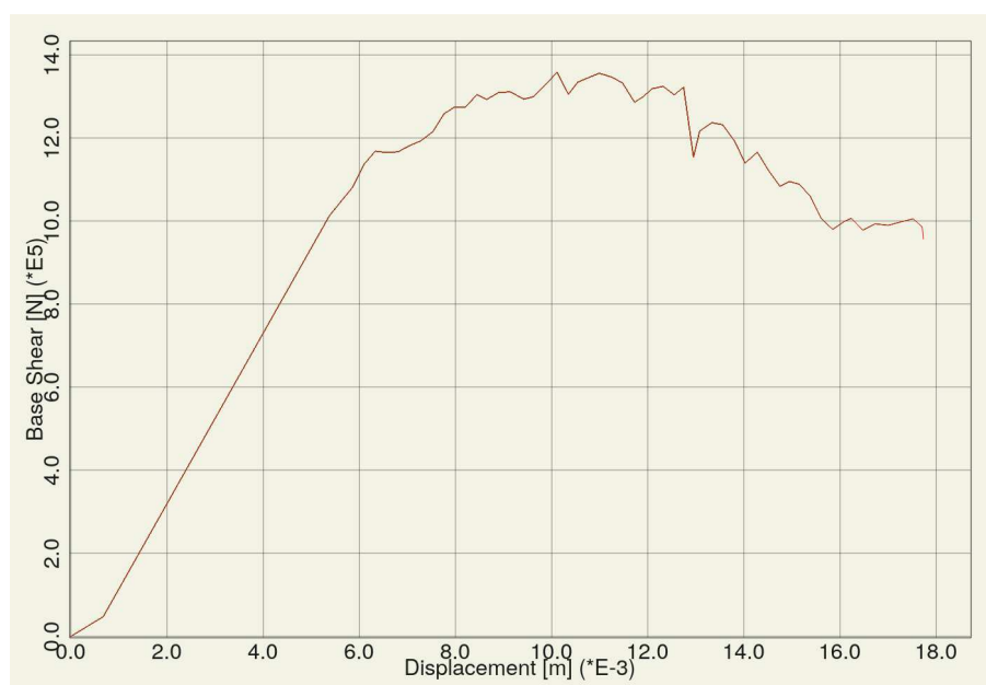
Abb. 6.7: Kapazitätskurve - Pushover-Analyse gemäß erster Eigenform
