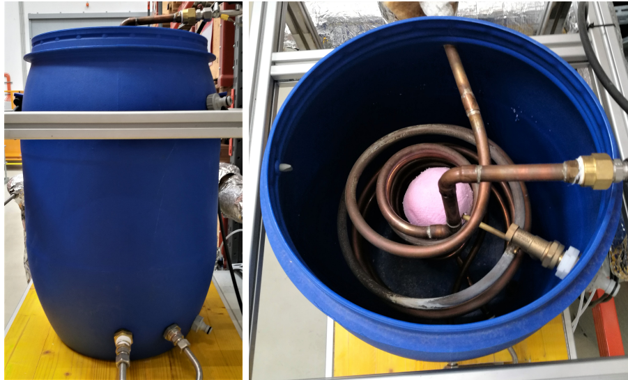
Abbildung 3.7: Behälter mit den innenliegenden Kopperspiralen und Schwimmerschalter
