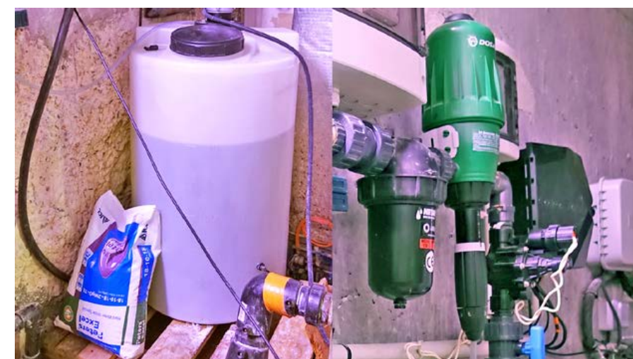
Abb. 226: Tank mit Flüssigdüngerlösung und Dosatron Proportionaldosierer
