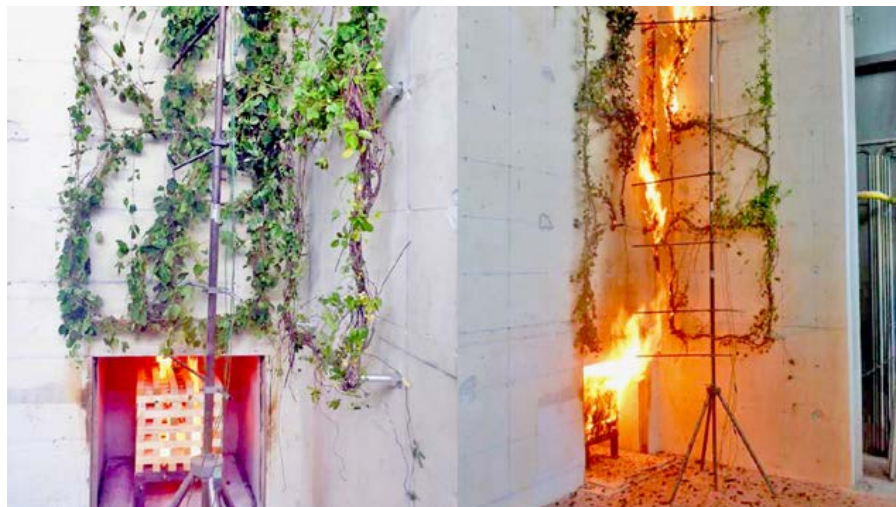
Abb. 132: Durchzündung - Begrünung ohne Abstand zur Brandkammer befestigt
