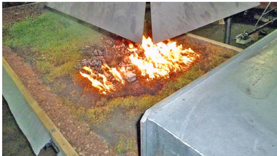
Abb. 334: Gründachaufbau bei Brandschutzprüfung
