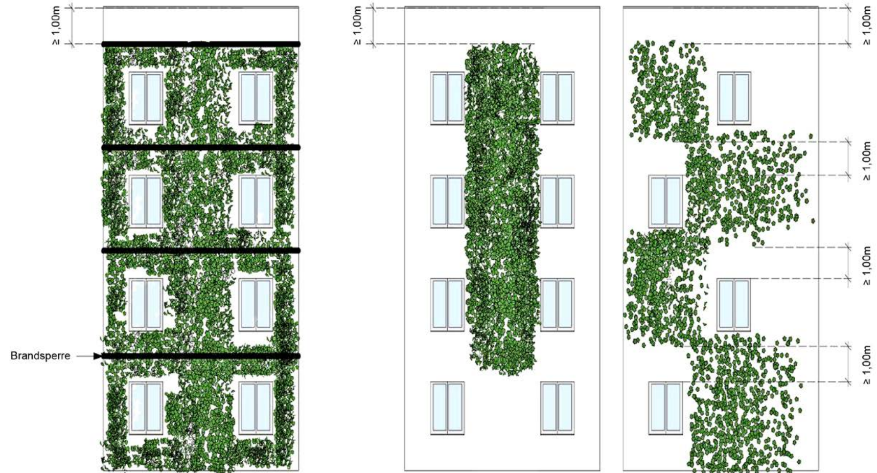
Abb. 129: Grünfassaden und Brandschutz - Schematische Darstellung verschiedener Möglichkeiten zur Anordnung von Fassadenbegrünungen
