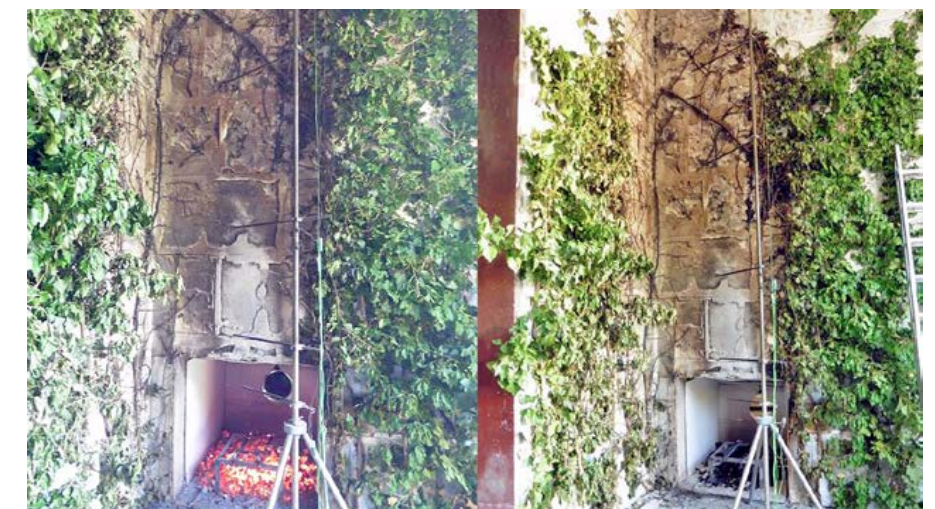
Abb. 131: Efeu nach der Prüfung - keine seitliche Brandweiterleitung erkennbar
