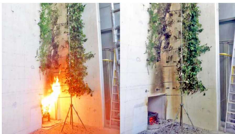
Abb. 134: Nach der Prüfung - Anforderungen der ÖNORM B 3800-5 positiv erfüllt
