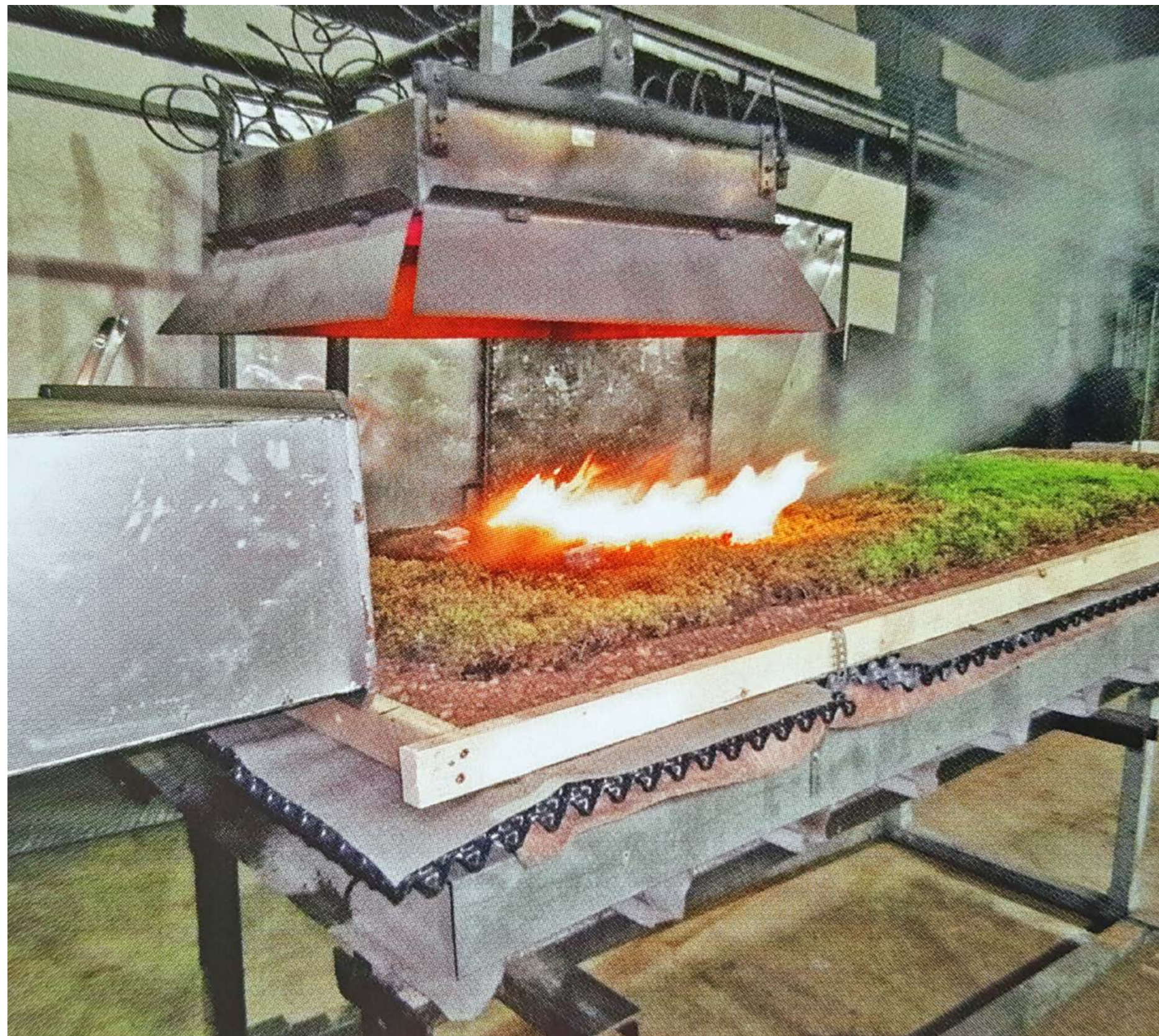
Abb. 70: Brandversuch - „Prüfverfahren 3“ mit Gründachaufbau, zwei Brandsätzen, Gebläse und Wärmestrahler
