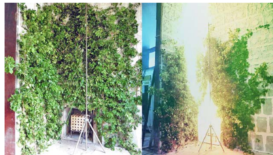
Abb. 130: Efeu, Prüfstand der MA 39 - vor und während der Fassadenbrandprüfung
