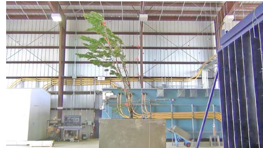
Abb. 183: Tests im Windkanal mit Windgeschwindigkeiten von bis zu 190km/h
