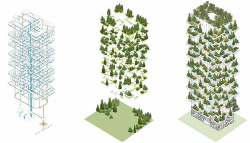
Abb. 177: Bosco Verticale - Bewässerungssystem und Vegetation
