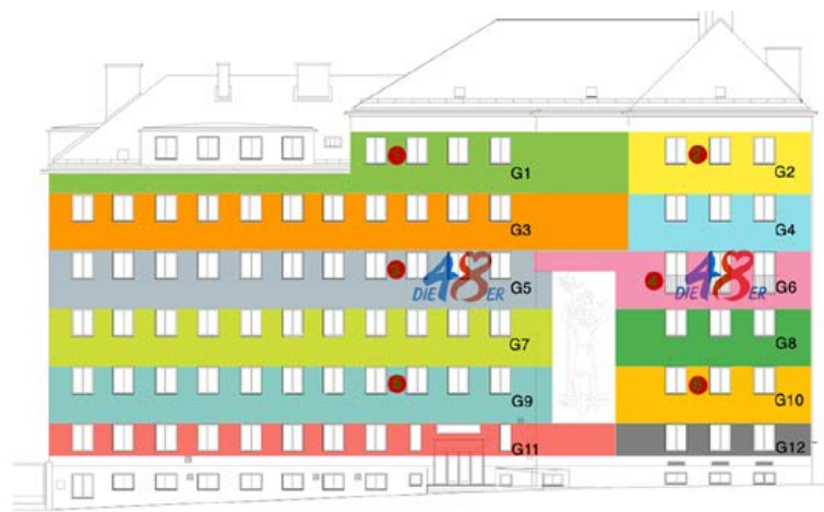
Abb. 264: Übersichtsplan - 12 Gießkreise versorgen die Grünfassade mit Wasser
