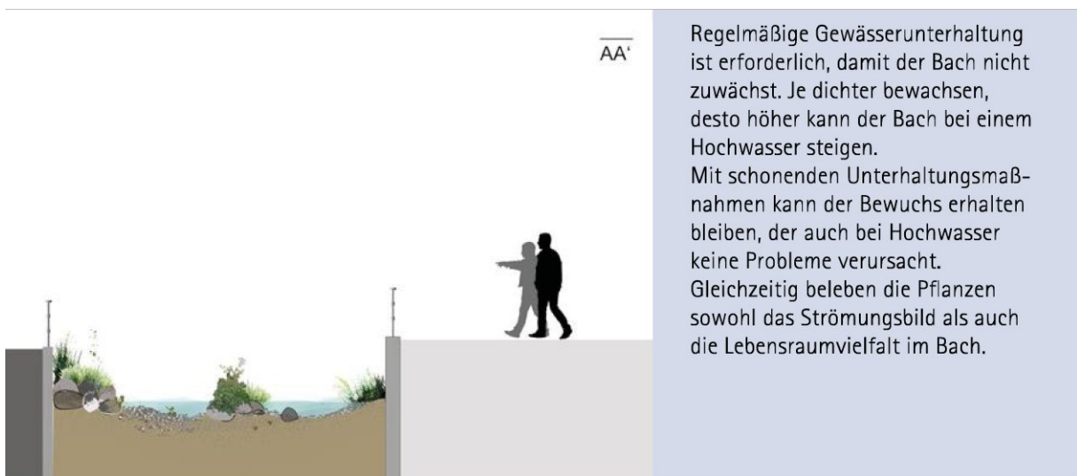
Abb. 121: Querschnitt einer Gestaltungsmöglichkeit eines Bachs mit beidseitiger Begrenzung (Quelle: LfULG Sachsen 2020: 39)
