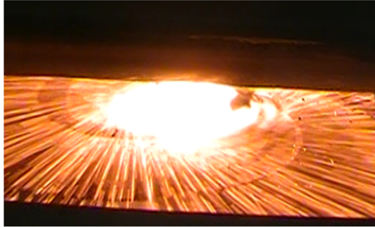
Abb. 2.5: Rotationszerstäubung auf einer Drehscheibe [13]
