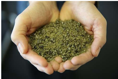
Abb. 2.6: Trocken granulierte Schlacke
