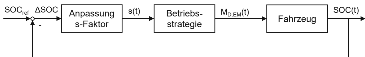
Abbildung 9: Regelkreis zur Adaption des Äquivalenzfaktors basierend auf dem Feedback des SOC der Batterie
