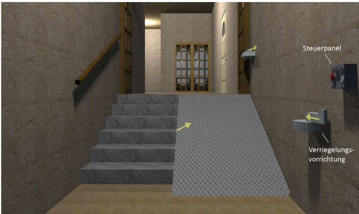
Abbildung 63: Treppenrampe heruntergeklappt; Quelle: eigene Darstellung
