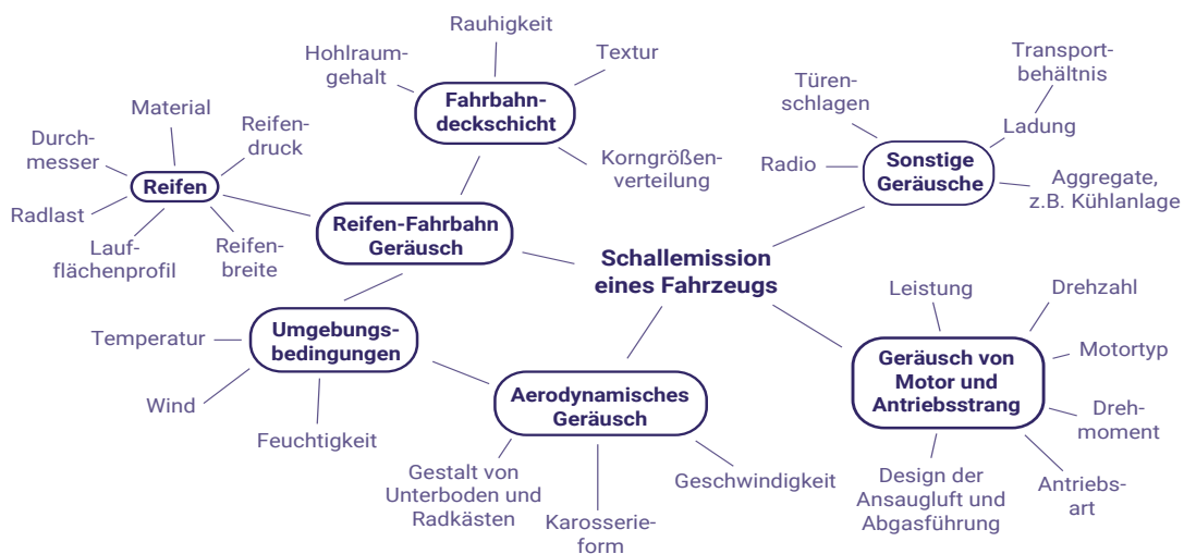
Abbildung 34: Viele Faktoren beeinflussen die Lärmemissionen der Fahrzeuge. Quelle: Eigene Darstellung nach ADAC 2006, S. 18
