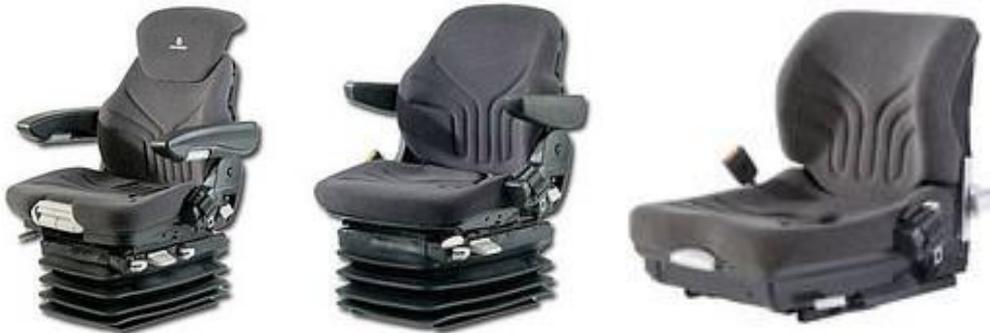
**Abbildung 22: Schwingungsgedämpfte Fahrersitze<sup>259</sup>**
