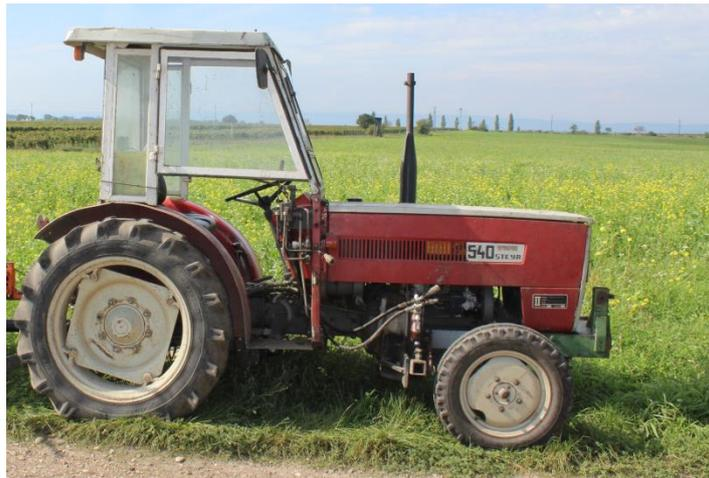
**Abbildung 18: Steyr 540 - Schmalspurtraktor<sup>221</sup>**
