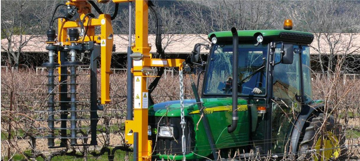
Abbildung 3: Manueller Rebschnitt mit schleppergeführter Vorschneidemaschine<sup>49</sup>
