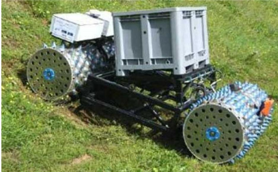
Abbildung 20: Selbstfahrendes Experimentalfahrzeug Geisi<sup>230</sup>
