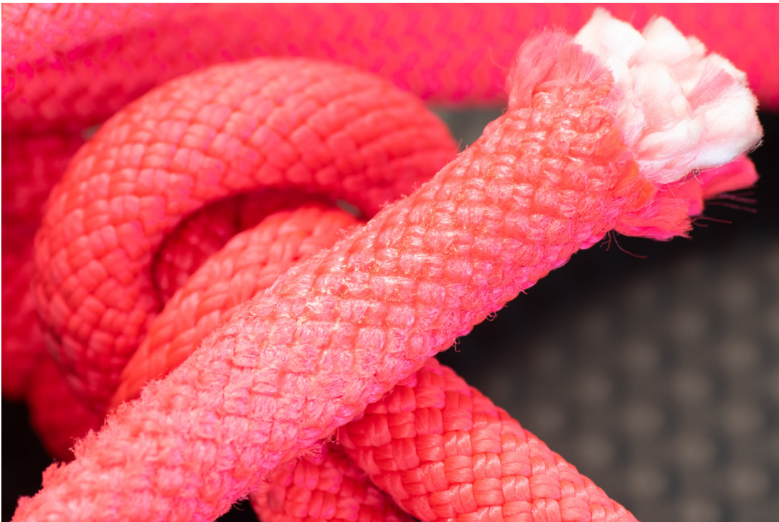
Abbildung 35: Testseil mit oberflächlicher Schmelzverbrennung
