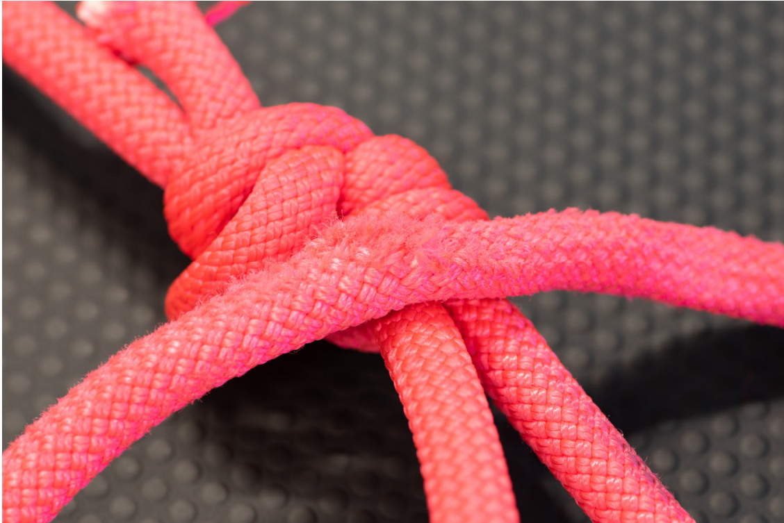
Abbildung 34: Aufgerissener Mantel des Testseils
