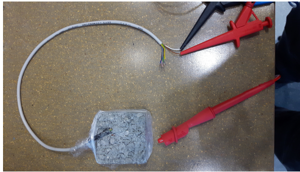
Abbildung 1: Die im Estrich eingebauten Feuchtigkeitssensoren werden mit einem Labornetzteil mit einer Spannung von 5 V versorgt und mit einem Multimeter wird deren Spannungsabfall, der proportional zur Kapazität der Sensoren ist, gemessen.
