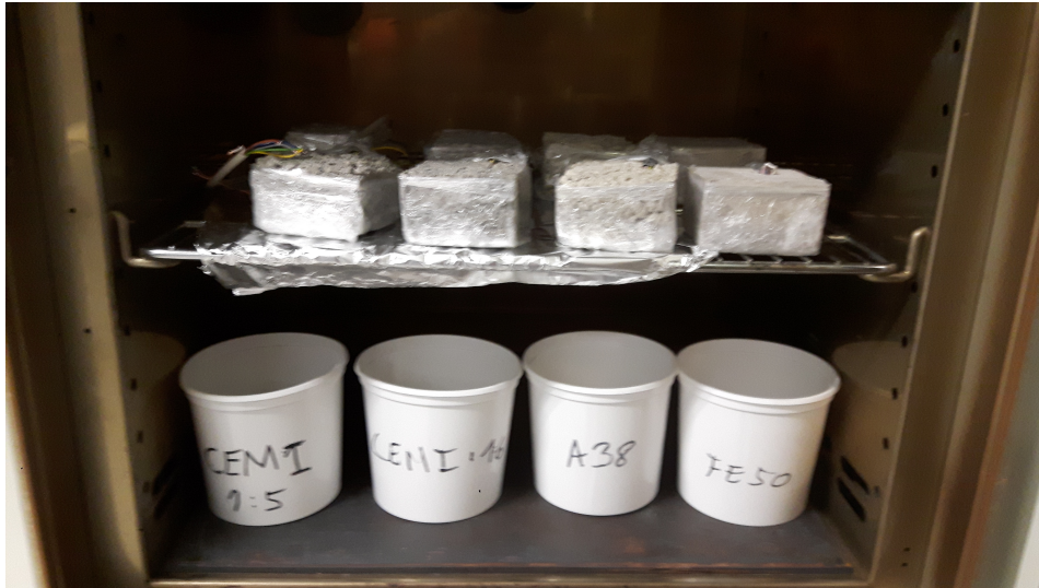
Abbildung 7: Alle Proben wurden gemeinsam unter den selben Bedingungen in einem Klimaschrank untergebracht.
